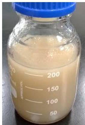
Figura 17 – Suspensão resultante da hidrólise ácida da fibra de juta branqueada com ácido ortofosfórico.
