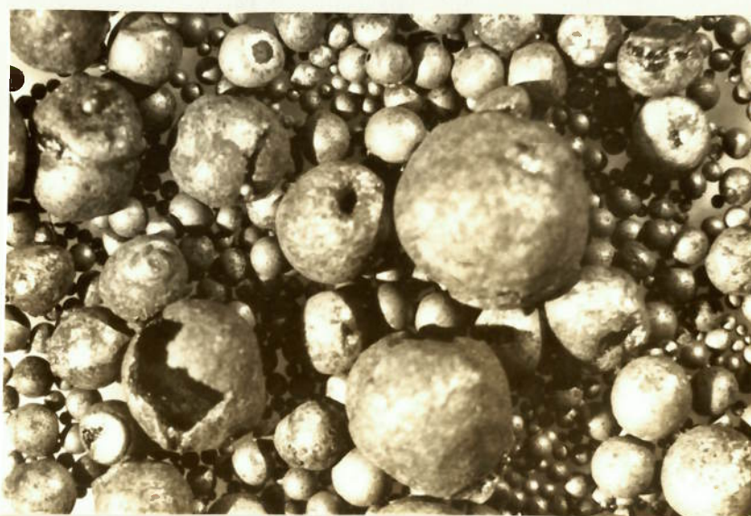
Fig. 2.6 - Fotografia das gotas limpas preparadas para o ensaio granulométrico.
