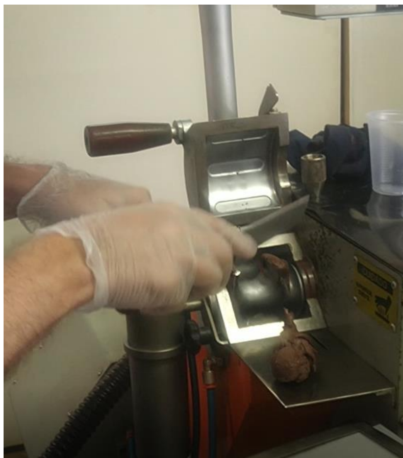
Figura 64: aspecto da amostra de ABS + cobre recoberto com polidopamina + SEBS-g-MA recém retirada da câmara de processamento drais
