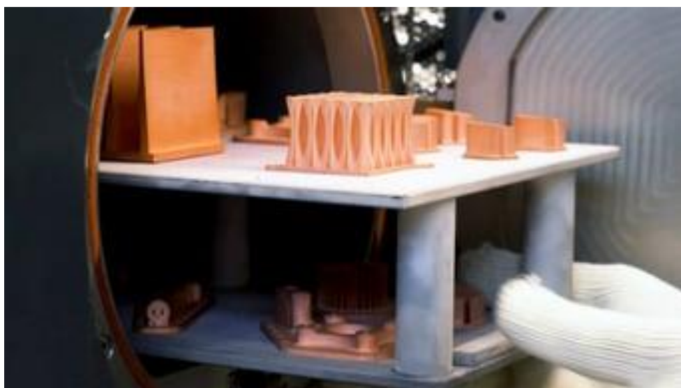
Figura 9: Peças de cobre 3D impressas na impressora Metal X da Markforged.
