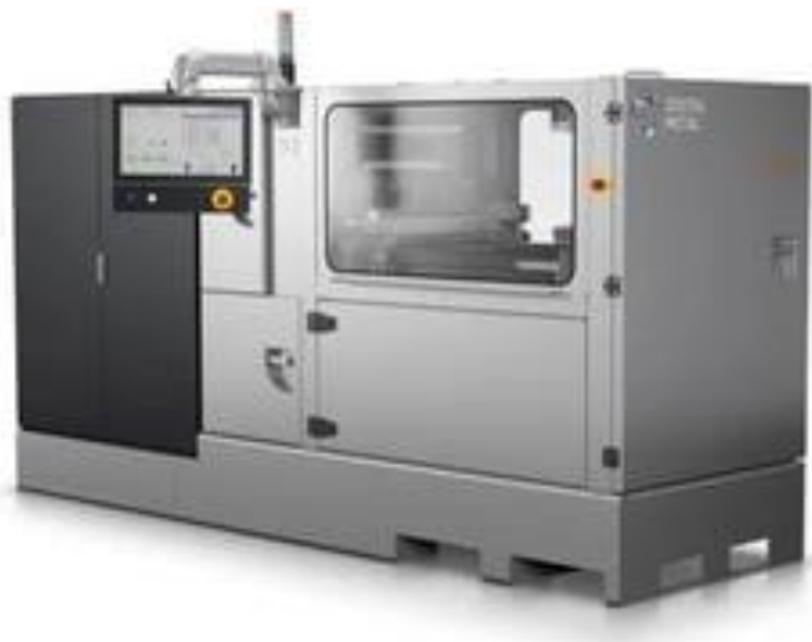
Figura 7: Impressora de cais aglutinante P2500 da Digital Metal com pó de cobre.
