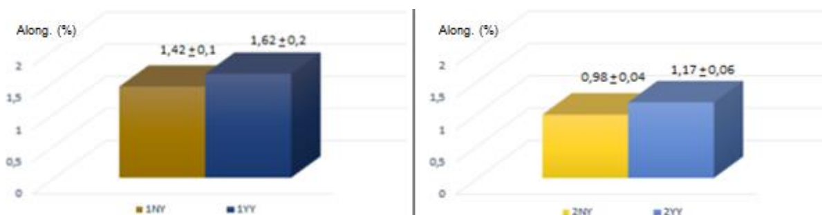
Gráfico 12: Alongamento na tração ISO527 (%) comparativo das amostras sem recobrimento (1NY e 2NY) versus amostras com recobrimento de polidopamina (1YY e 2YY), ou seja, 1NY versus 1YY e 2NY versus 2YY.
