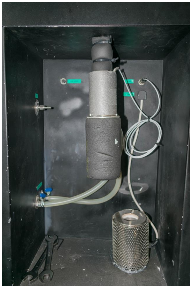
Figura 22. Equipamento para ensaios de adsorção de H_2 . Quantachrome, modelo iSorb HP.
