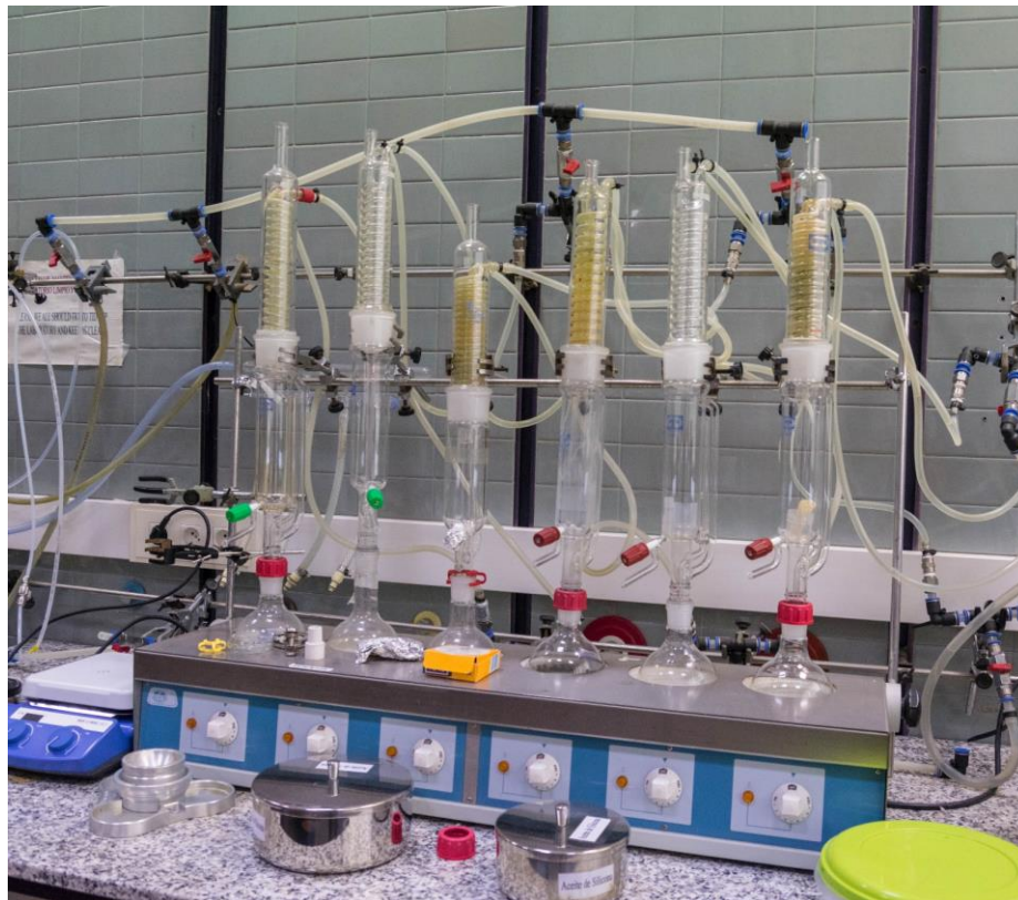
Figura 7. Soxhlet utilizado para a lavagem dos carvões ativados por KOH e H_3PO_4 .
