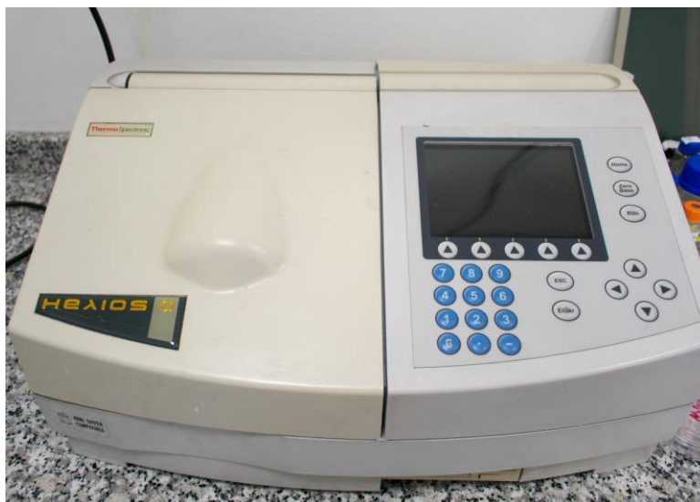
Figura 12. Espectrofotômetro utilizado para medição de absorvância.
