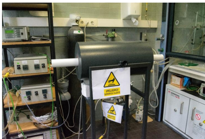
Figura 8. Forno utilizado na ativação por H_3PO_4 .
