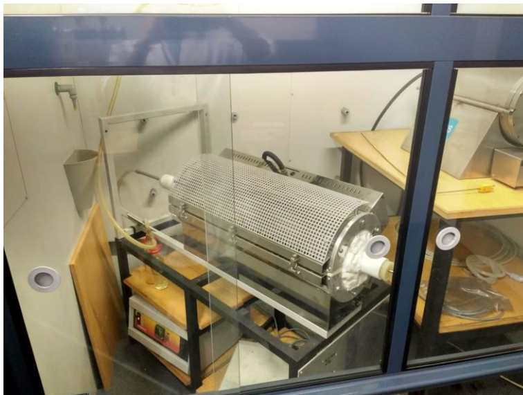
Figura 6. Forno utilizado na carbonização, ativação por KOH e ativação por Fe 2 O 3 .
