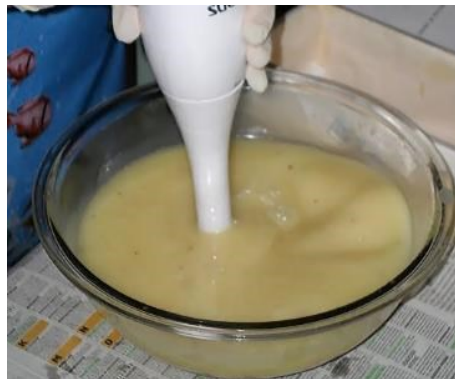
Figura 4: Ilustração do ponto de traço da mistura de óleos, gorduras e soda cáustica, durante a reação de saponificação.
