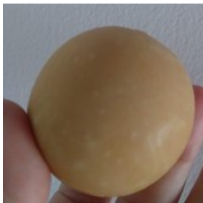
Figura 63: Amostra de esfera de sabonete de 2 polegadas para teste de aceitação
