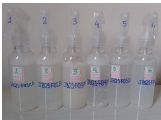
Figura 73: Solução de sabonete a 2 % m/m para ensaio de microabrasão.
