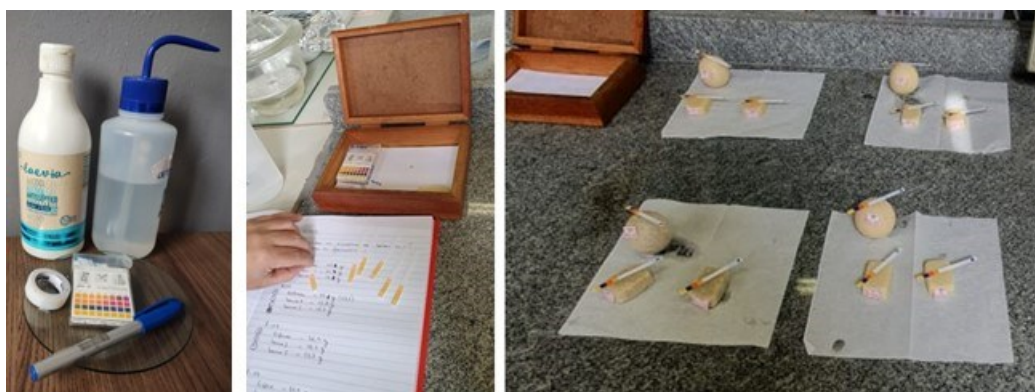
Figura 64: Medição de Ph dos sabonetes com fita indicadora de Ph - MColorPhast™ Ph 0 a 14 Ph - Universal Indicator.
