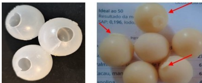
Figura 67: Molde de polímero não informado pelo fabricante- molde 2 e esferas de sabonete levemente deformadas.
