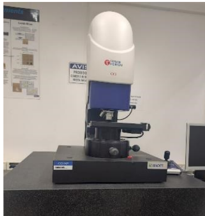
Figura 39: Perfilmetro ótico 3D CCI MP.
