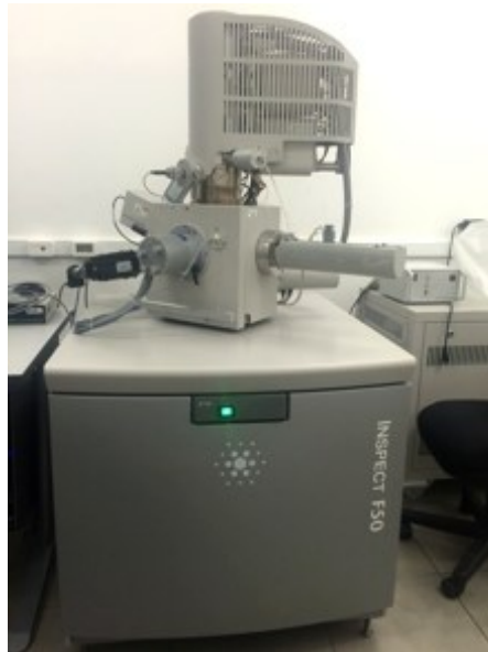
Figura 30: Microscópio eletrônico de varredura com canhão de efeito de campo - FEG - Inspect 50.
