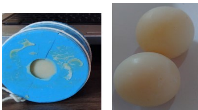
Figura 70: Molde de silicone fabricado pela autora para produção de sabonetes no formato de esferas de 1 polegada e esferas de sabonete de 1 polegada sem deformação.
