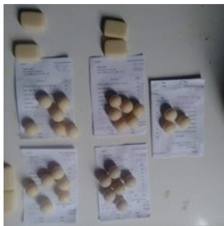
Figura 62: Amostras de sabonetes em barra de 20gr e esferas de 1 polegada para ensaio de microabrasão.
