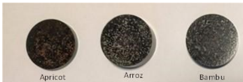
Figura 33: Amostras embutidas e lixadas.
