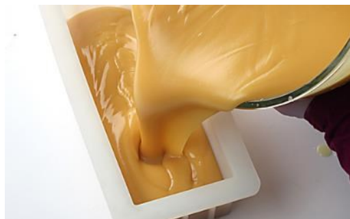
Figura 5: Ilustração do ponto de traço da mistura de óleos, gorduras e soda cáustica, após a reação de saponificação.
