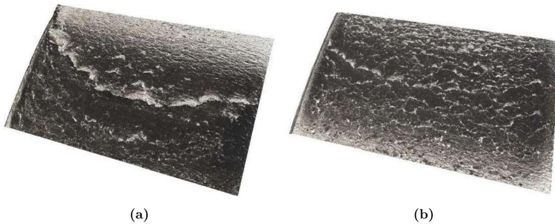
**Figura 49:** Perfilometria exemplificando a (a) trinca mestra e (b) a concentração maior de trincas de FCR, ambos observadas na região de transição da ZAC logo após os vales de deformação.
