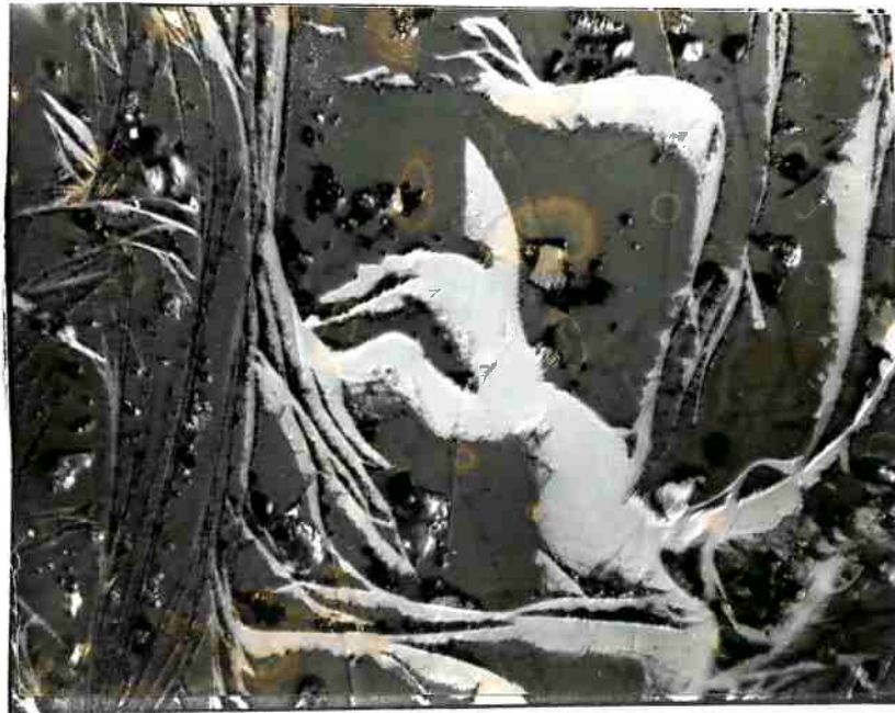
Figura 4.2.22 Micrografia da liga Nd_{80}Fe_{20} solidificada a 15 K/min em ensaio de ATD, mostrando eutético lamelar contendo domínios magnéticos.
