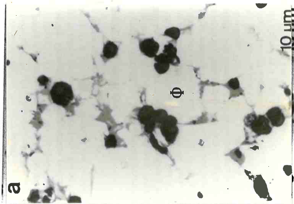
Figura 2.1.3. Micrografia ótica de ímã, mostrando óxido de Nd e fase rica em Nd.(FIDLER et al. 1989)
