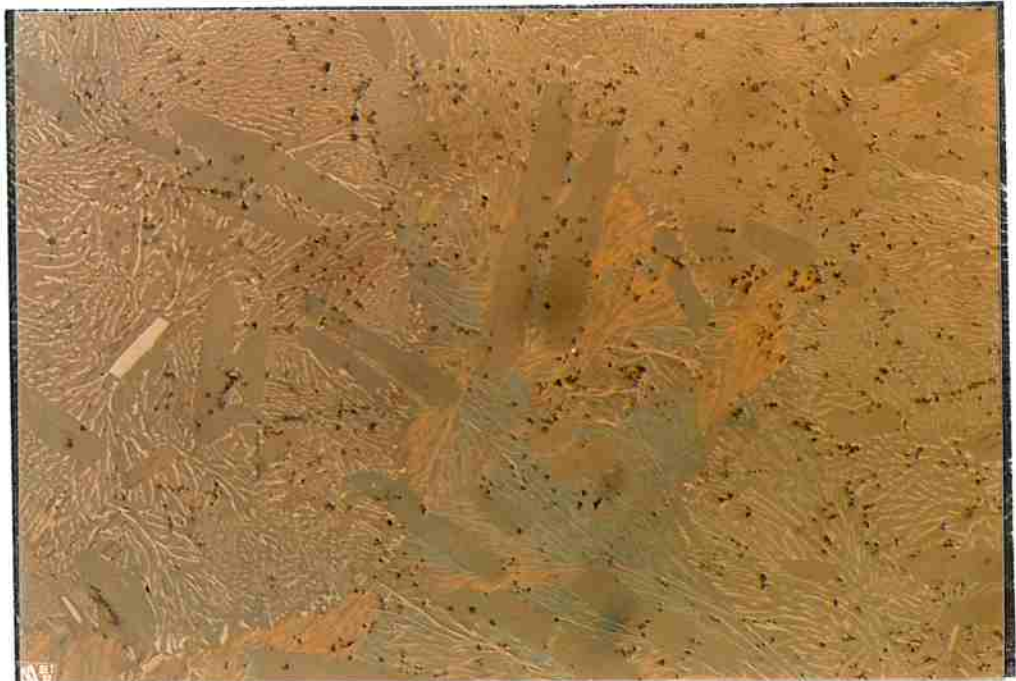
Figura 4.5.1 Microestrutura da liga \text{Nd}_{65}\text{Fe}_{35} submetida a ensaio de ATD, contendo a fase proeutética \text{Nd}_2\text{Fe}_{17} , halo e dendritas de \text{Nd}-\alpha , e o eutético \text{Nd}_2\text{Fe}_{17} + \text{Nd}-\alpha . 1000x. (foto X45).
