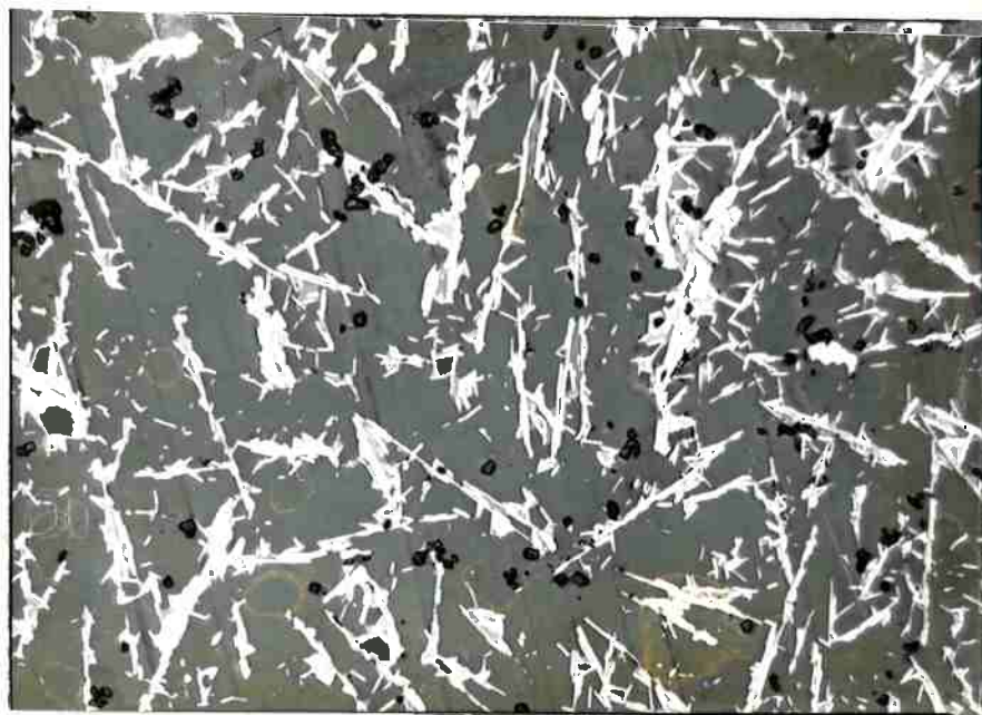
Figura 4.2.16 Microestrutura de liga \text{Nd}_{80}\text{Fe}_{15}\text{B}_5 tratada a 600^{\circ}\text{C} , mostrando agulhas da fase \phi numa matriz de Nd. (800x) (foto X-78).
