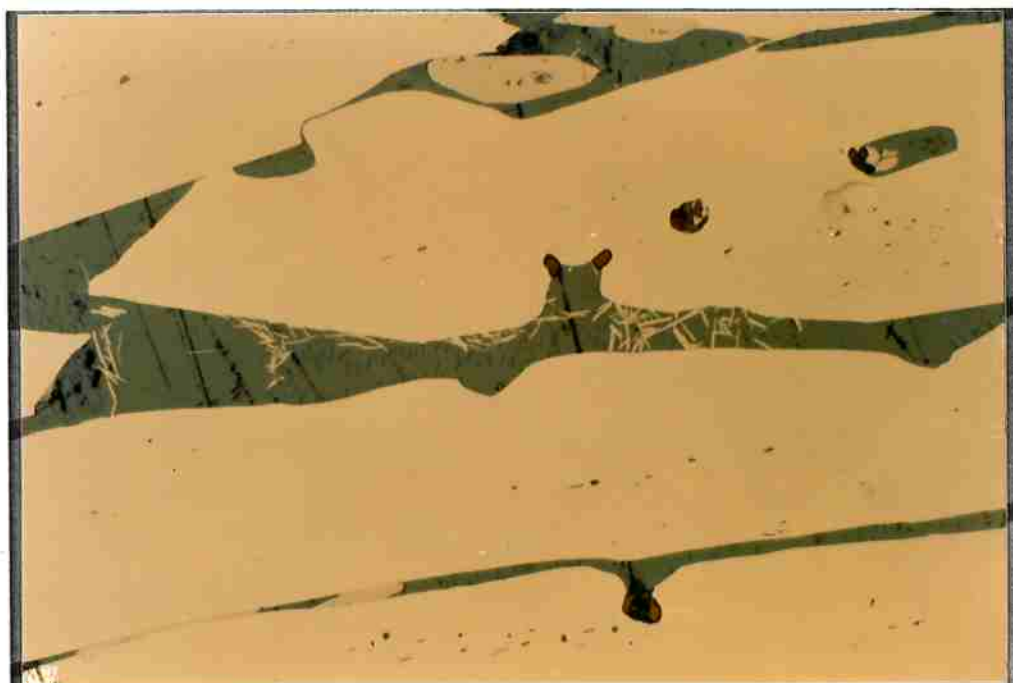
Figura 4.7.6 Microestrutura da liga Nd 17 Fe 76 B 7 na condição "liquada" + tratamento térmico, mostrando alteração microestrutural da região intergranular. (800x) (foto C34-21).
