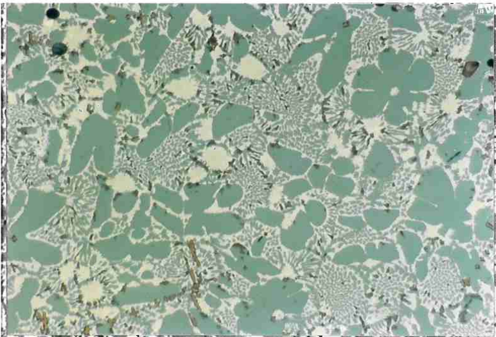
Figura 4.2.10 Microestrutura da liga \text{Nd}_{80}\text{Fe}_{15}\text{Al}_5 bruta de fusão, mostrando dendritas de Nd e o constituinte bifásico. (800x) (foto C35-2).
