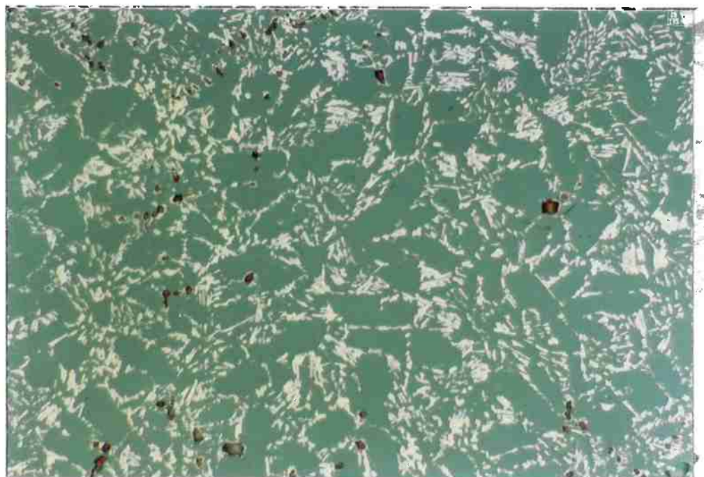
Figura 4.2.17 Microestrutura de liga \text{Nd}_{80}\text{Fe}_{15}\text{O}_5 tratada a 600^\circ\text{C} , mostrando óxidos, matriz de Nd e a fase \text{Nd}_2\text{Fe}_{17} . (200x) (foto C26-4).
