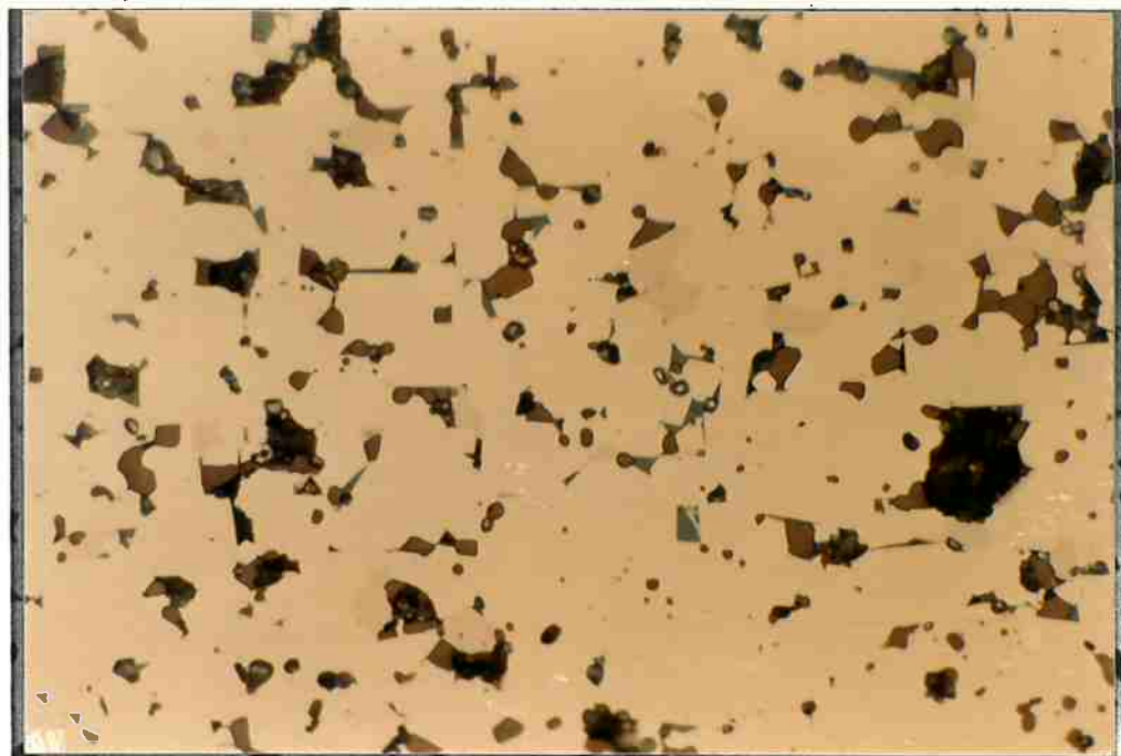
Figura 4.7.9 Microestrutura do ímã L22.5, "re-sinterizado" a 1050°C por meia hora e resfriado a 200 K/min. (foto 34-23).
