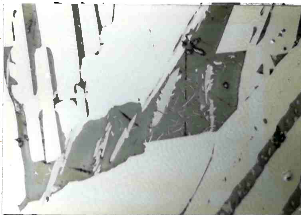
Figura 4.2.13 Microestrutura de liga Nd 90 Fe 10 tratada a 600°C, mostrando a matriz Nd-α, fase A 1 acicular, óxidos e fase irregular (provavelmente Nd 2 Fe 17 ) (200x) (foto C26-1).
