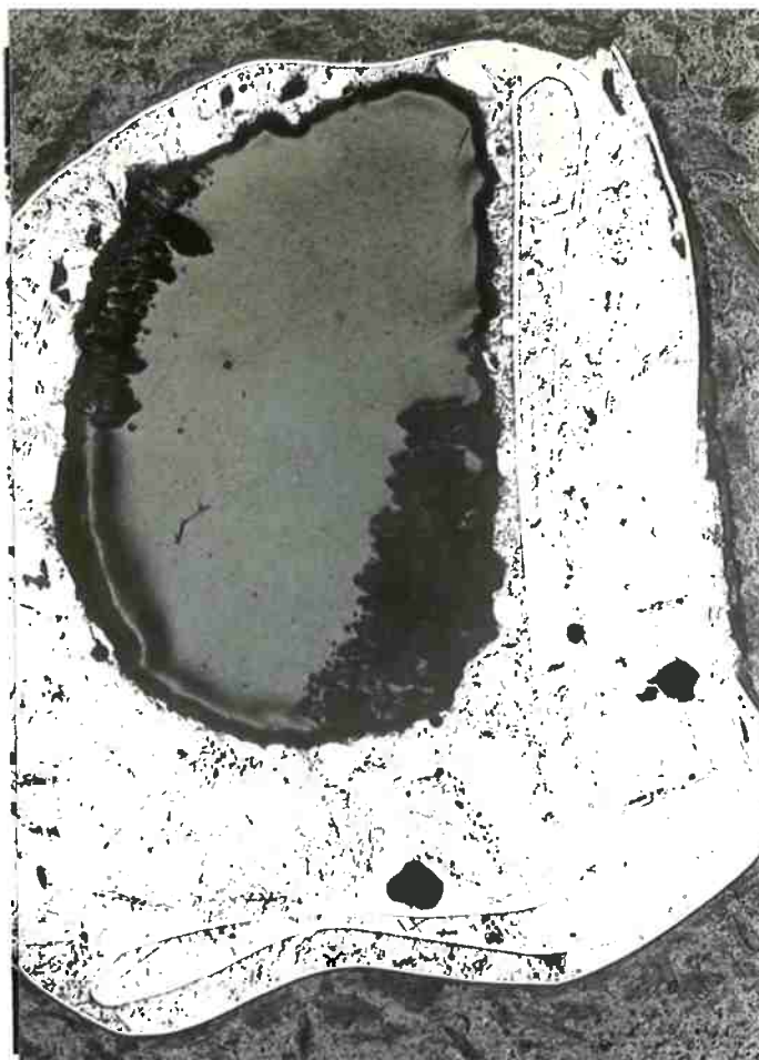
Figura 4.6.6 Microestrutura da liga \text{Nd}_{60}\text{Fe}_{37,3}\text{B}_{2,7} ATD, mostrando aspecto geral de amostra embrulhada em Ta. 30x. (foto 5-31).
