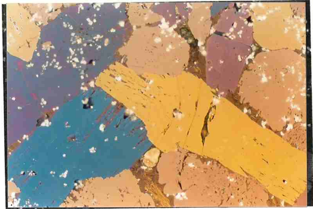
Figura 4.4.2 Microestrutura de amostra \text{Nd}_{30}\text{Fe}_{70} aquecida a 715^\circ\text{C} , mostrando a fase \text{Nd}_5\text{Fe}_{17} polarizada e o eutético polarizável na região intergranular (160x) (foto C34-20).
