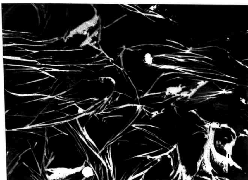
Figura 4.6.14 Presença de domínios magnéticos no eutético lamelar de liga \text{Nd}_{60}\text{Fe}_{37,3}\text{B}_{2,7} ATD.
