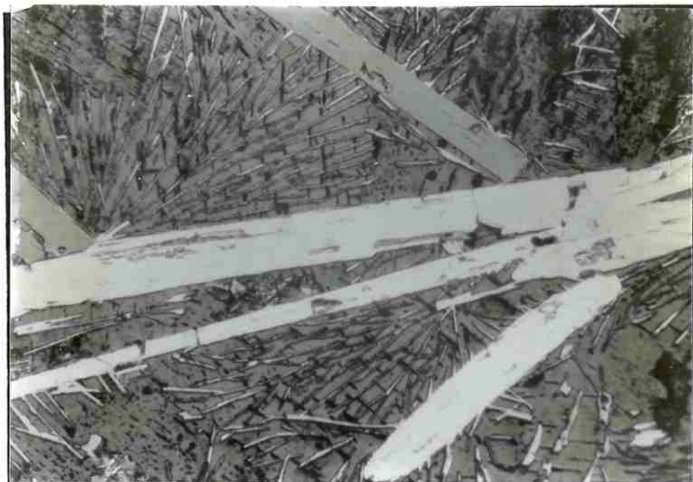
Figura 4.6.9 Microestrutura de amostra \text{Nd}_{60}\text{Fe}_{20}\text{B}_{20} ATD, mostrando três plaquetas da fase \rho polarizadas em tons diferentes. 250x. (foto C37- )
