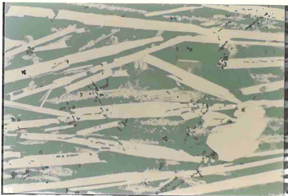
Figura 4.2.15 Microestrutura de liga \text{Nd}_{40}\text{Fe}_{53,5}\text{B}_{6,5} tratada a 600^{\circ}\text{C} , mostrando grãos da fase \phi e a fase acicular crescendo em torno das plaquetas da fase \eta . (400x) (foto C34-5)
