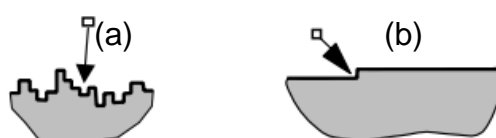
Figura 1 – Interface atômica (a) rugosa ou (b) lisa (STEFANESCU, 2009) segundo o modelo TLK.
