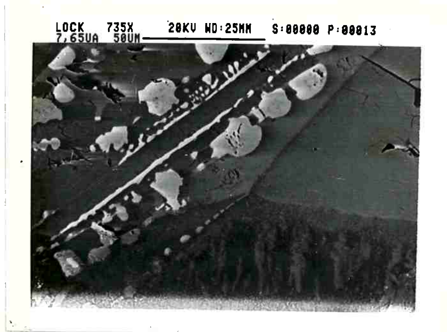
FIGURA 49- Imagem de elétrons retroespalhados (composição) - Aspecto da comportamento do Fe Nb (cinza) com as ca madas de FeNb+Nb C e de FeNb+NbC (inferior). Aumento 735X.
