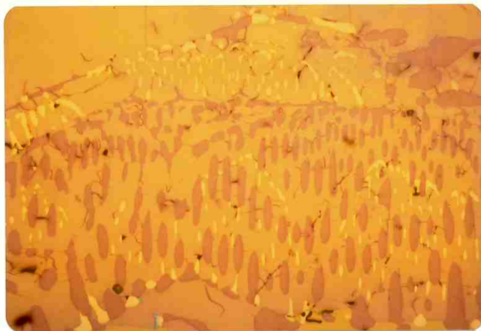
FIGURA 28- Precipitação de nióbio e NbC no eutético de Fe-Nb. Ataque anódico. Aumento 100X.
