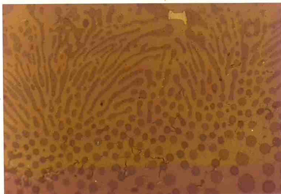
FIGURA 29- Detalhe da variação morfológica do nióbio, entre globulares e bastonetes. Ataque anódico. Aumento 100X.
