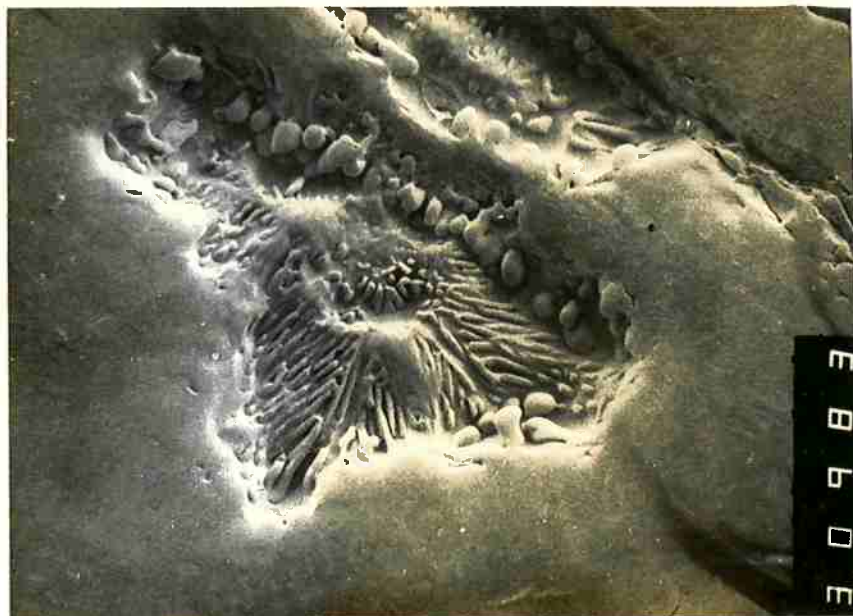
FIGURA 30- Imagem de elétrons secundários. Aspecto espacial da morfologia do nióbio. Evidencia-se a morfologia globular e de bastonetes. Ataque profundo HND /HF 1:1. Aumento 300X.
