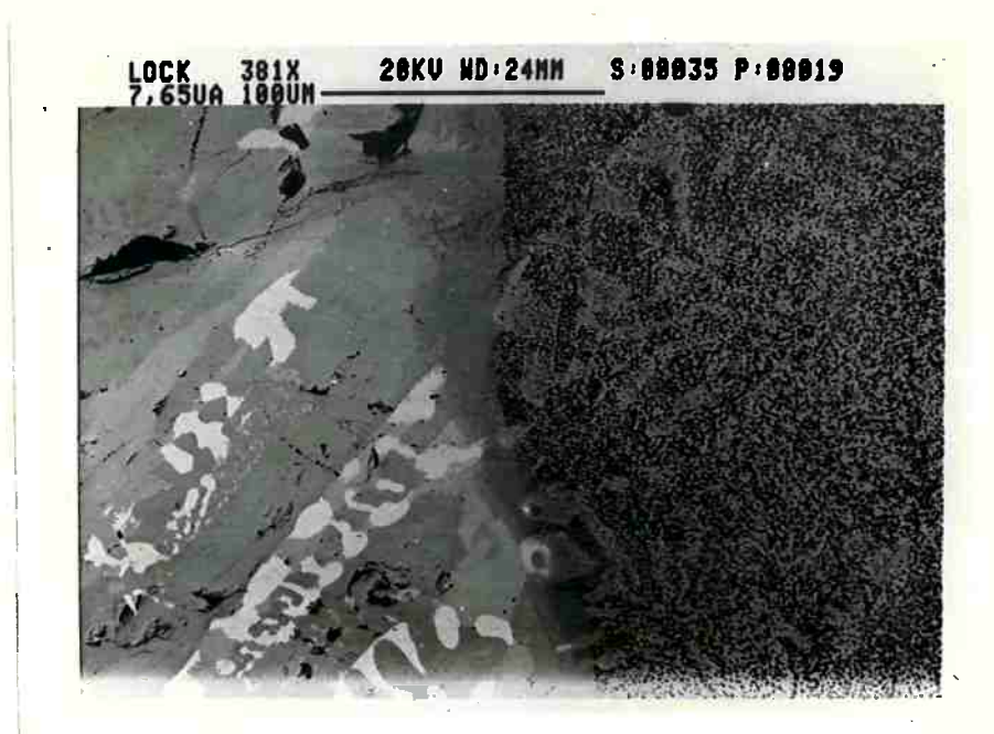
FIGURA 46- Imagem de elétrons retroespalhados (composição) - Aspecto geral da reação na região eutética. Aumento 381X.
