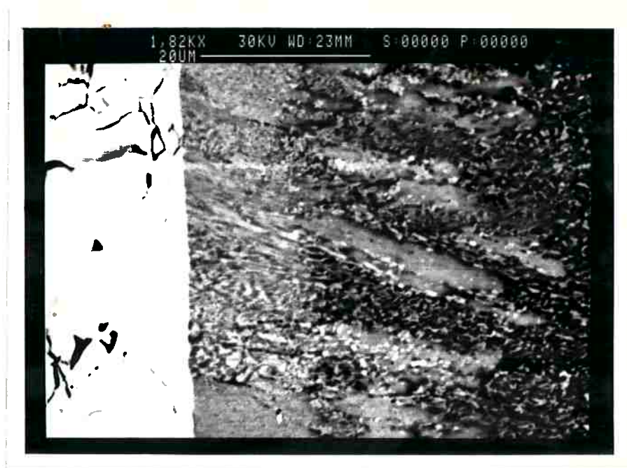
FIGURA 45- Imagem de elétrons retroespalhados (composição) - Mesmo aspecto da figura anterior. Pode-se observar também as camadas de Fe Nb+NbC (direita) e de FeNb+NbC 2 (centro-direita). Aumento 1820X.
