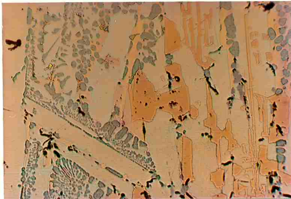
FIGURA 24- Morfologia do eutético da liga Fe-Nb. Precipitação de glóbulos de nióbio eutético (lilás) e Fe Nb 23 (alaranjado) . Ataque ácido oxálico 10%. Aumento 100X.
