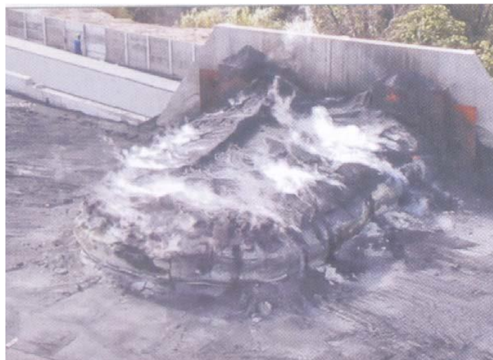
Figura 9 - Forno tipo Acheson de resistência em U, pertencente à SICBRAS, localizada na Bahia no Município de Simões Filho.
