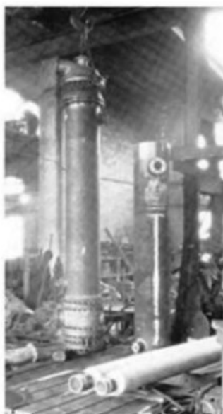
Figura 3-2 - Aplicação do aço inoxidável duplex 453S, desenvolvido na Suécia na indústria de papel e celulose [5].
