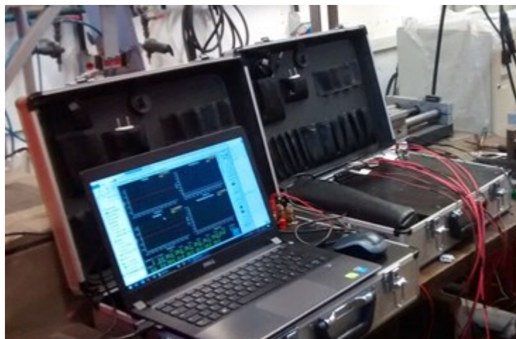
Figura 4-6 - Sistema de aquisição instantânea de dados, composto de maletas de aquisição (parâmetros de soldagem e ciclos térmicos) e computador portátil para leitura e exportação de dados.
