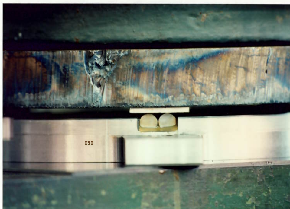
Fig. 4.3. Detalhe da colagem dos roletes de interface
