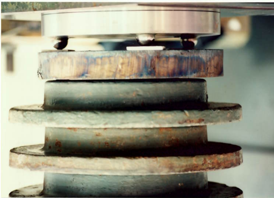
Fig. 4.2. Detalhe da colagem das esteras de interface
