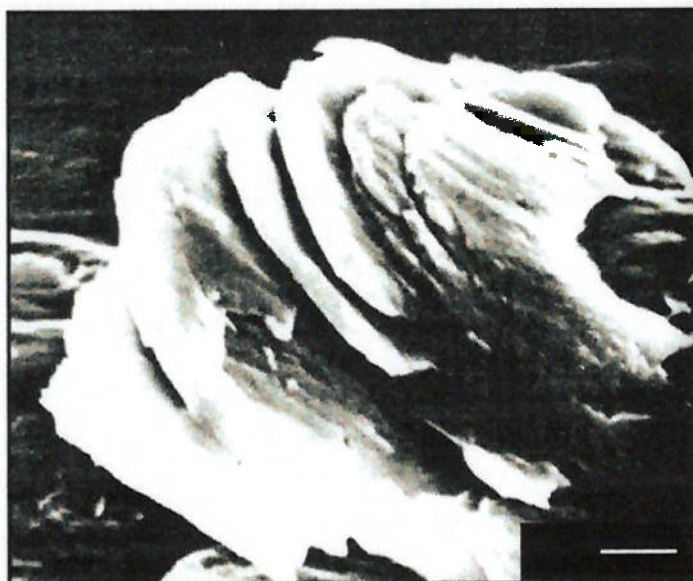
Figura 3. 2. Partícula transferida que consiste de lâminas emplilhadas ( slip-tongues ) a qual foi destacada da superfície e transferida para a superfície oposta segundo o modelo de Kayaba 18 .
