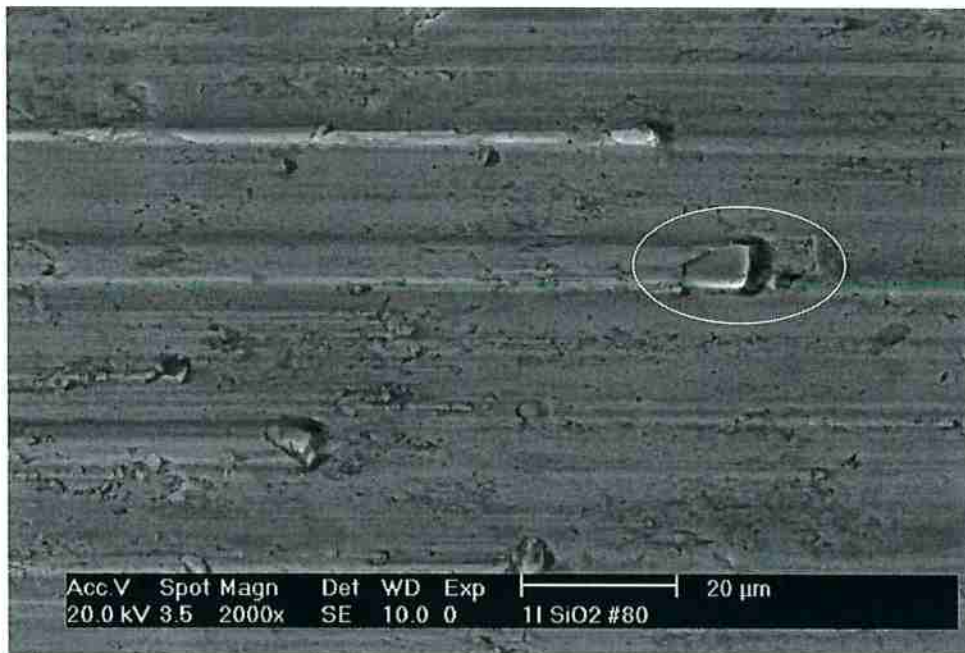
Figura 50- Afloramento à superfície do carboneto tipo MC. Ensaio com lixa #80 e H_a/H = 1,0 .
