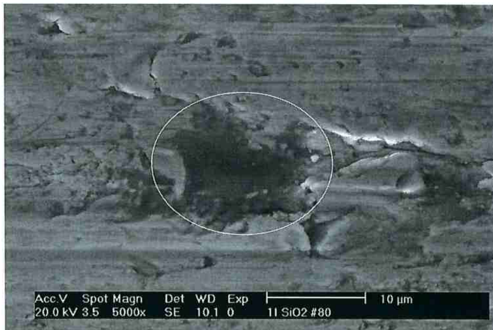
Figura 51 - Destacamento do carboneto tipo MC. Ensaio com lixa #80 e Ha/H = 1,0 .
