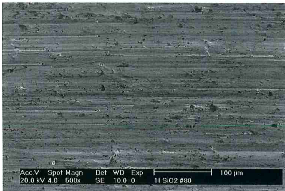
Figura 48 - Imagem dos sulcos encontrados na superfície do pino. Ensaio com lixa #80 e Ha/H = 1,0 .
