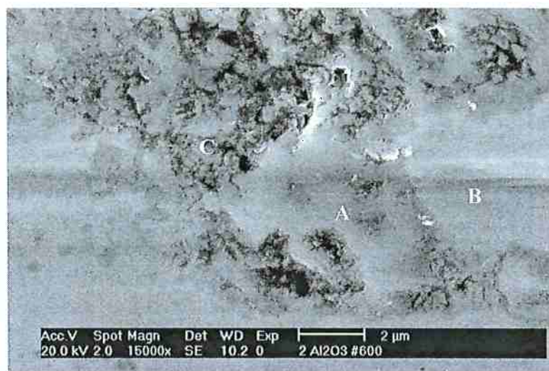
Figura 44 - Imagem de um carboneto do tipo MC fraturado durante o ensaio. Ensaio com lixa de #600 e H_a/H = 2,8 . A) material da matriz depositado em espaço deixado pelo carboneto MC fraturado; B) sulco na matriz; C) carboneto tipo MC fraturado.
