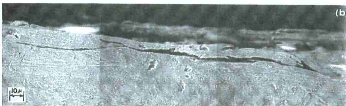
Figura 6 - Formação de trincas sub-superficiais à pista de desgaste; cobre comercialmente puro; imagem da secção transversal paralela à pista de desgaste (SUH, 1973).
