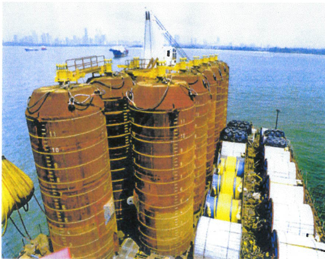
FIGURA 1.1 - Âncoras de sucção do sistema de ancoragem do FPSO "Northern Endeavour", no convés de um rebocador. [2]
