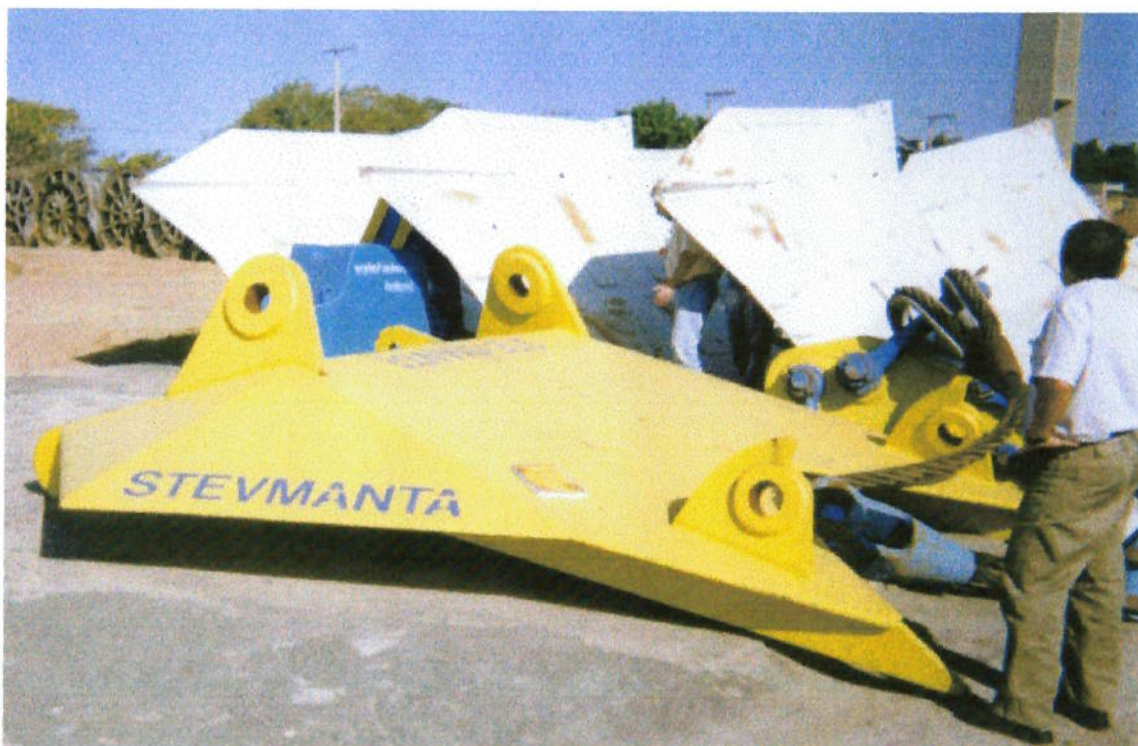
FIGURA 2.13 - Pata da âncora STEV MANTA de 11\text{m}^2 .
