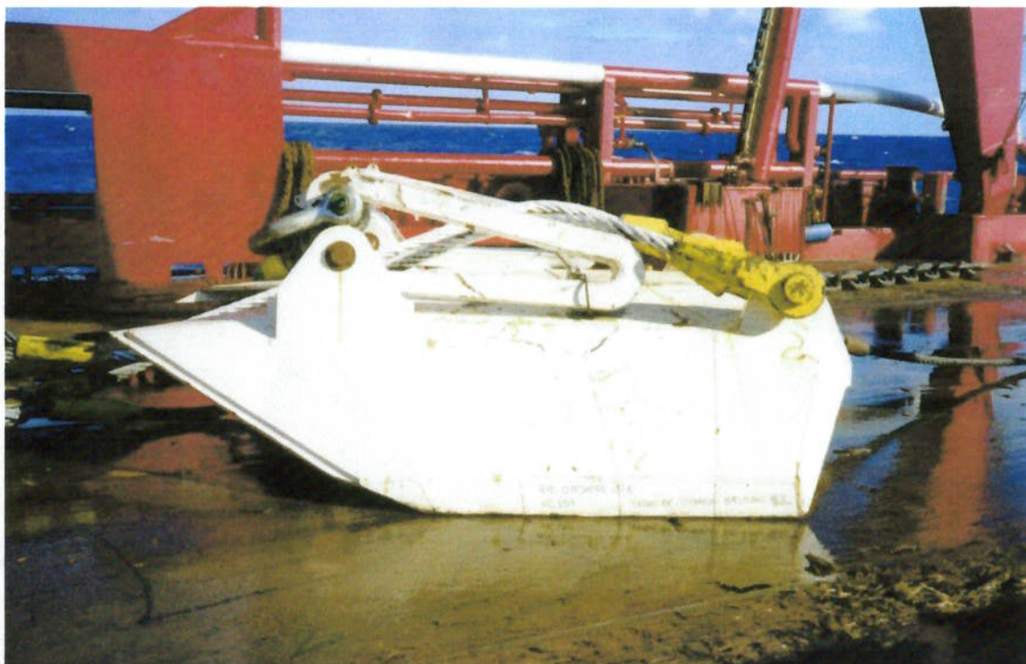
FIGURA 2.10 - Protótipo da âncora CENO-ROF com área projetada de pata de 10\text{m}^2 , no convés do rebocador Far Saylor.
