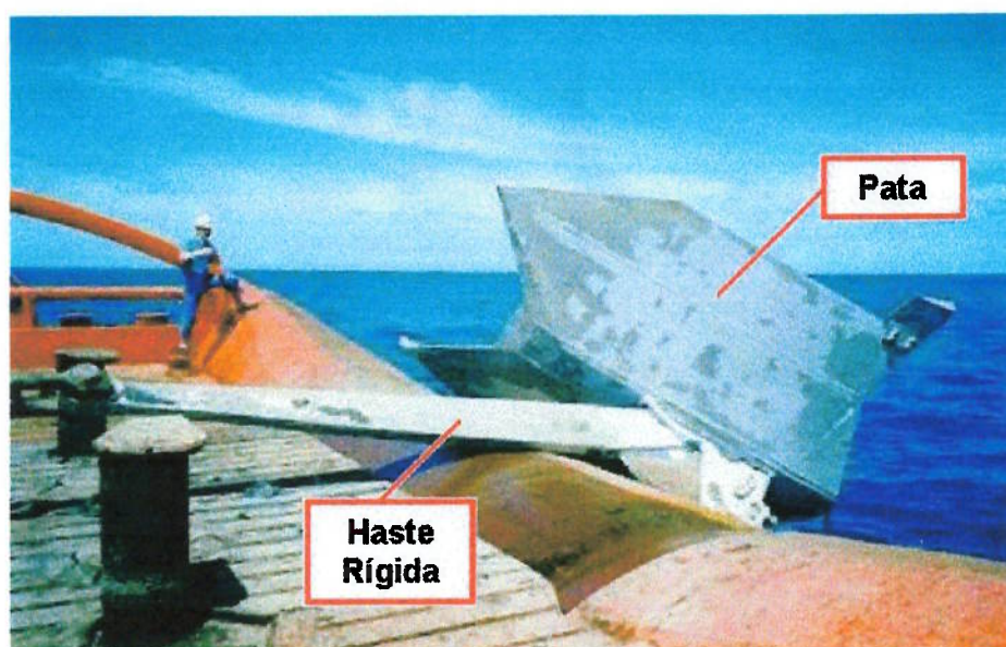
FIGURA 1.12 - Âncora DENLA MK3 de 10m 2 no convés de um rebocador. [11]
