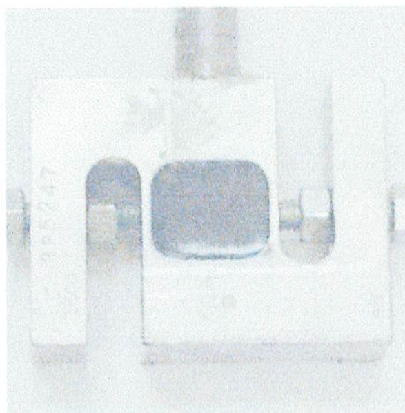
FIGURA 3.14 - Célula de carga utilizada para medição dos esforços na linha de cravação. [17]
