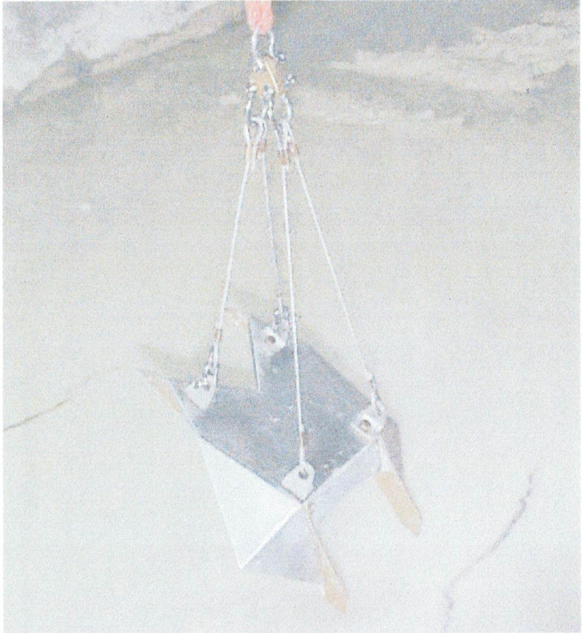
FIGURA 3.3 - Modelo em escala 1:20 da âncora STEV MANTA.
