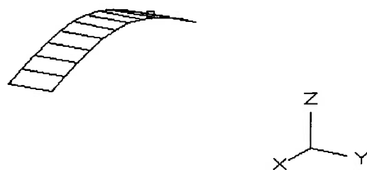
Figura 73. Primeiro modo de flexão vertical estimado pelo STAR (91 rad/s)
