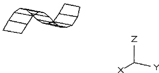
Figura 74. Segundo modo de flexão vertical estimado pelo STAR (299 rad/s)
