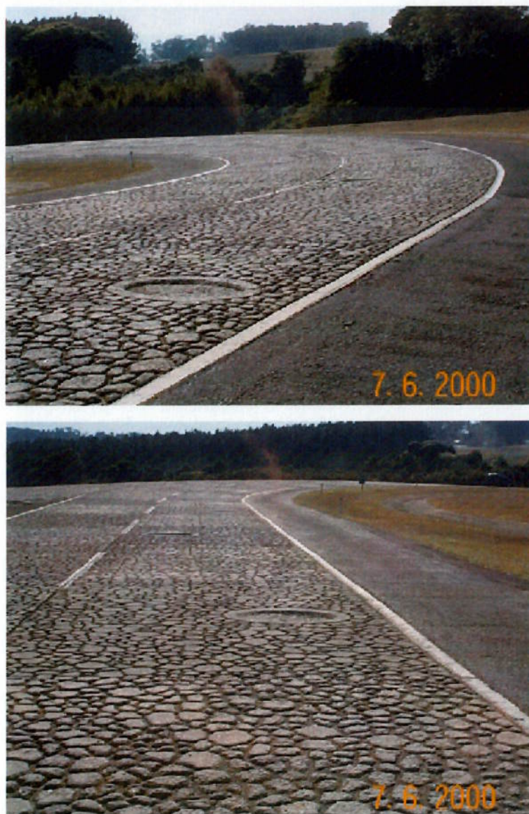
Figura 4.3 – Trechos de Pista com Buracos de Maior Amplitude Utilizados na Simulação de Entrada de Batente
