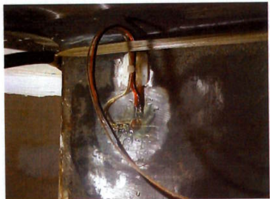
Fig. 6.5 Extensômetro com cabos.
