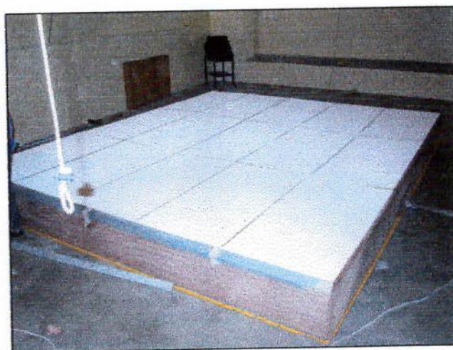
Fig.5.8: Amostra sem vedação montada na câmara reverberante.
