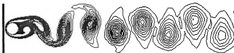
Figura 4-48 - Contorno de vorticidade para Re=200 em torno de um cilindro fixo (sem rotação - \alpha = 0 ), em vários instantes de tempo diferentes: a) t^* = 3.075 , b) t^* = 30.0 , c) t^* = 60.0 e d) t^* = 90.0 .
