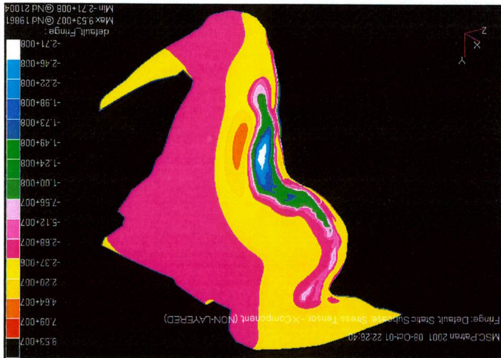
Figura 107 Tensão normal radial \sigma_x (Pa) na litosfera continental da Placa Sul-Americana ( T_e = 100 km).
