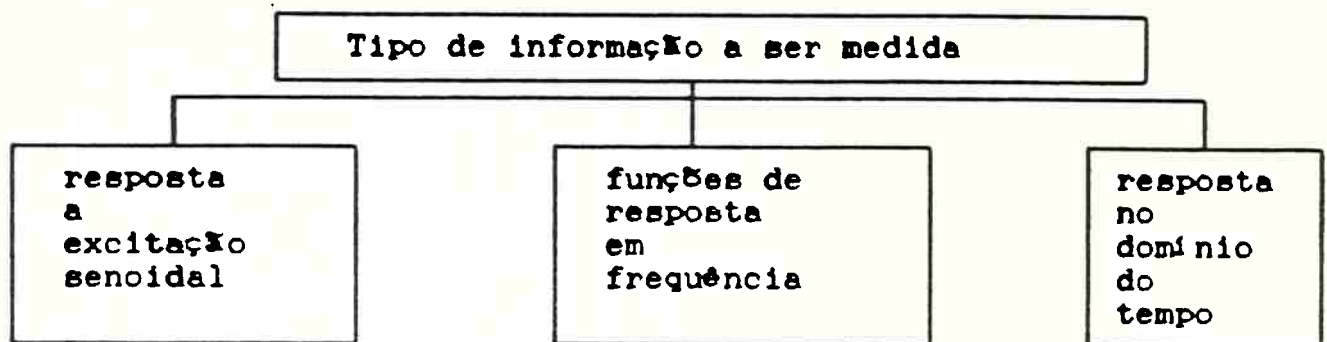
Fig. 2 Critério de classificação dos métodos de análise modal segundo o tipo de informação requerida.
