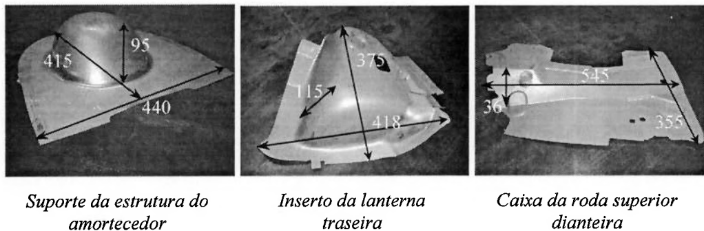
Figura 5-1 – Componentes estampados adotados para a reconstrução.
