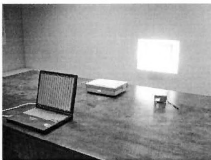
Figura 3-1 – Equipamentos do sistema de recuperação de forma.
