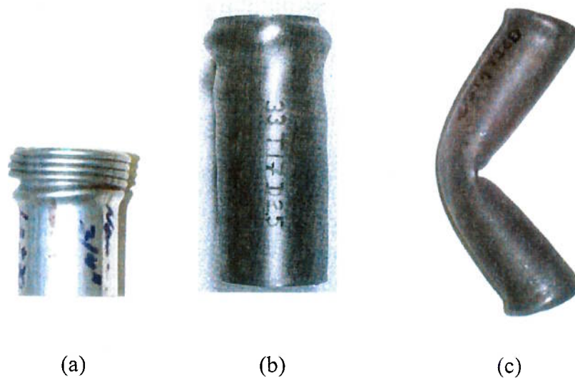
Figura 2 – Tipos de flambagem. (a) Flambagem dinâmica progressiva (Gallina, 2004). (b) Flambagem dinâmica plástica (Jones, 1997). (c) Flambagem global.
