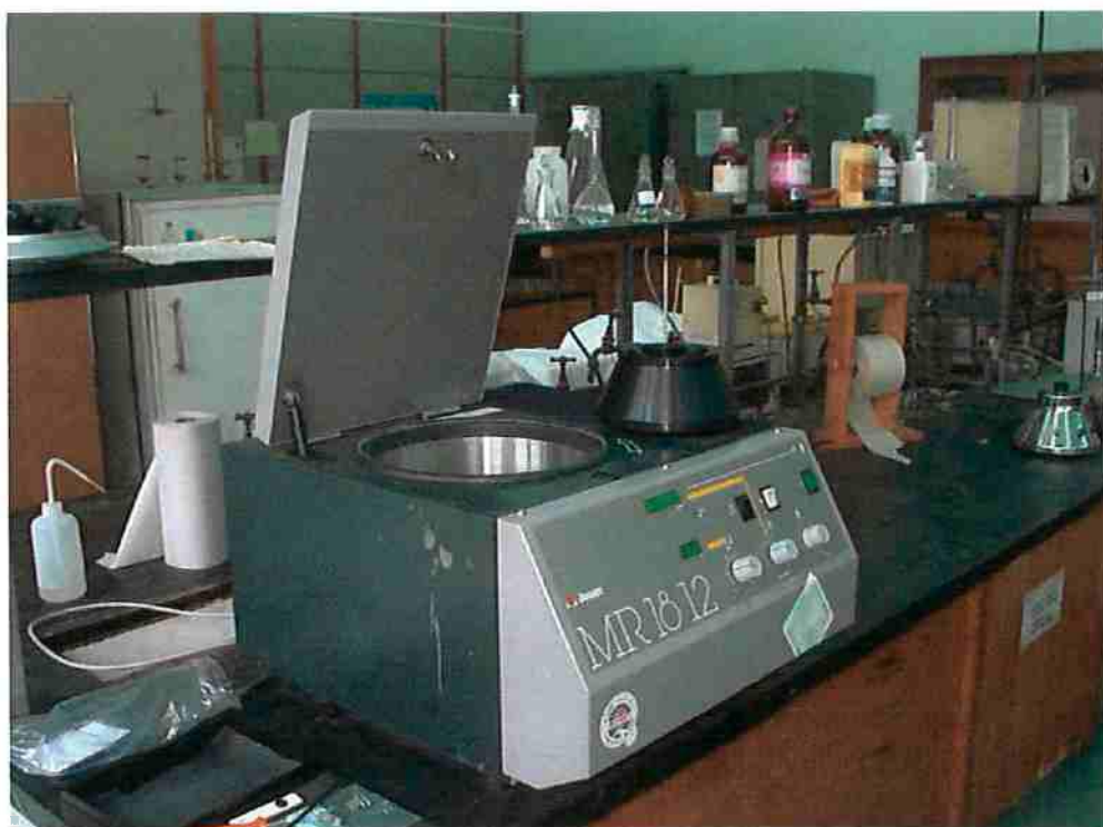
FIGURA 3.2 - Aparelhagem experimental utilizada nos ensaios de centrifugação.
