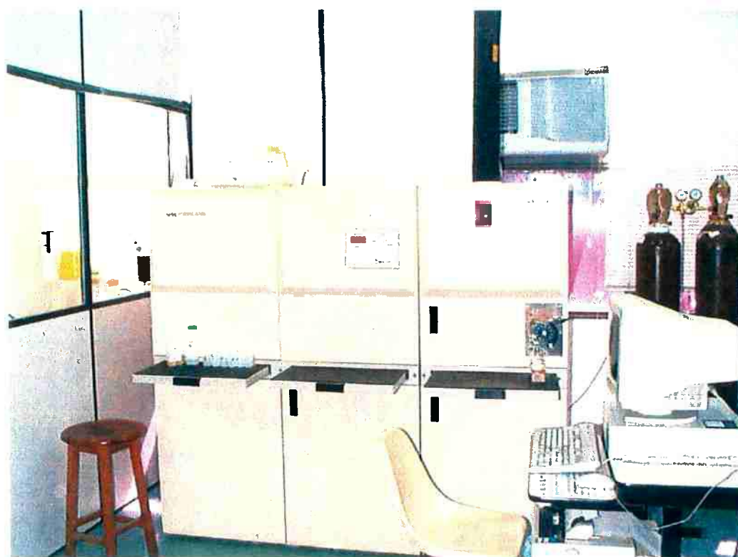
FIGURA 3.6 – Arranjo experimental do ensaio de fotometria de chama.
