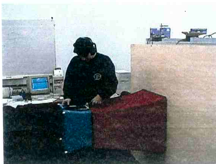
Figura 8.1: Uso do medidor de vazão tipo coifa para acerto da vazão de referência em ensaio
