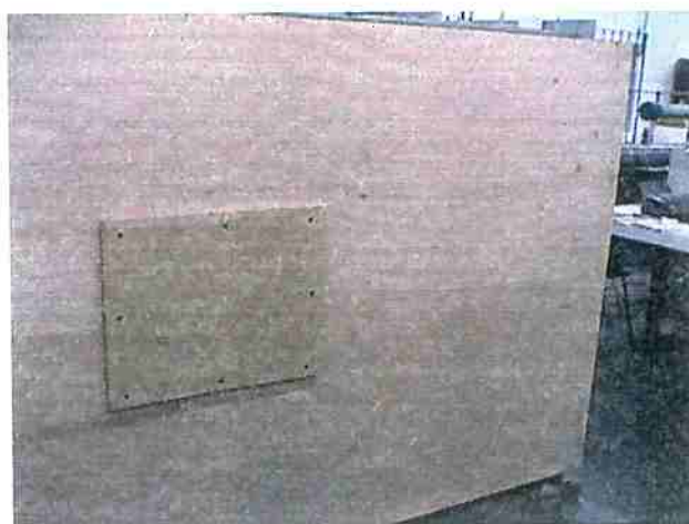
Figura 7.12: Vista da câmara plenum preparada para teste de vazamento
