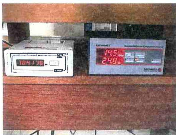
Figura 3.4: Foto a) Vista frontal do túnel de vento. Observa-se o dispositivo adaptador que representou a passagem curta, o canhão do anemômetro laser e seu braço posicionador. b) Medidores de pressão atmosférica e temperaturas de bulbo seco e de ponto de orvalho.
