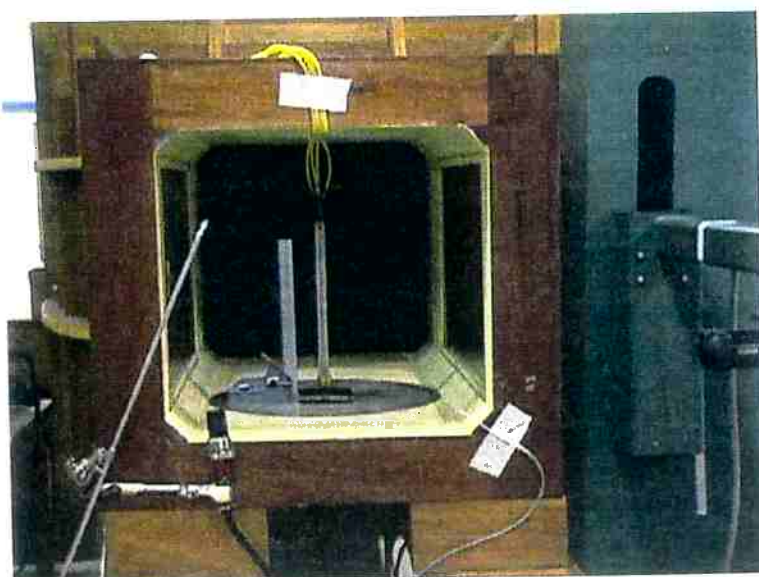
Figura 5.4: Vista frontal da seção de testes do túnel de vento. Corpo de prova em processo de posicionamento. Observa-se tubo de Pitot, e sensores de TPO e TBS.
