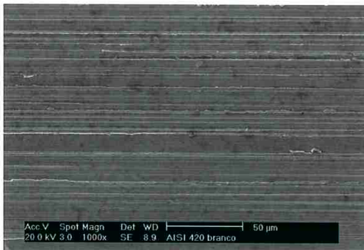
Figura 41 Superfície do aço AISI 420 polida com lixa 320.
