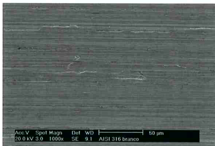
Figura 40 Superfície do aço AISI 316 polida com lixa 320.
