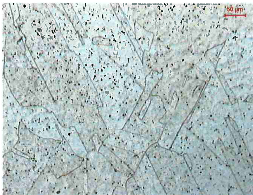
Figura 24 Microestrutura do Aço AISI 316 para o desgaste por cavitação (200X, Ácido Oxálico 10%).
