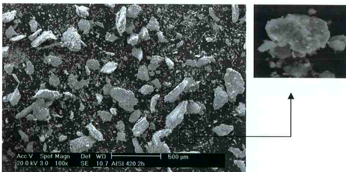
Figura 68 Imagem por MEV das partículas de desgaste após 3000 m do aço AISI 420.
