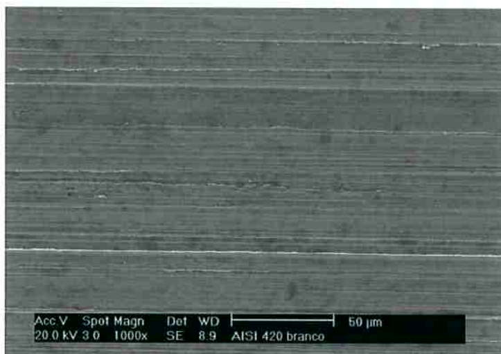
Figura 62 Superfície do aço AISI 420 com lixa 320.
