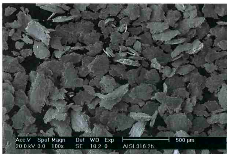
Figura 66 Imagem por MEV das partículas de desgaste após 3000 m do aço AISI 316.
