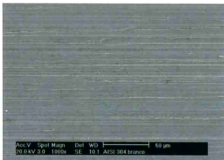
Figura 39 Superfície do aço AISI 304 polida com lixa 320.
