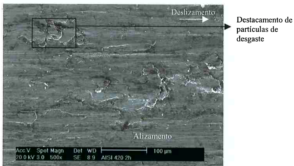
Figura 65 Superfície do disco do aço AISI 420 com 120 minutos de desgaste a seco.
