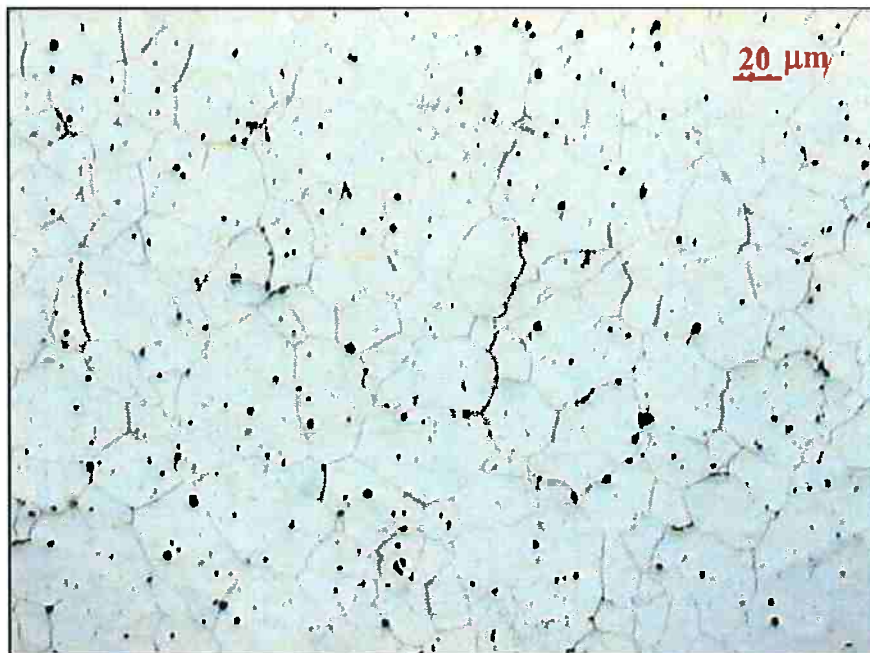
Figura 20 Microestrutura do Aço AISI 304 para o desgaste por deslizamento (100X, Ácido Oxálico 10%).
