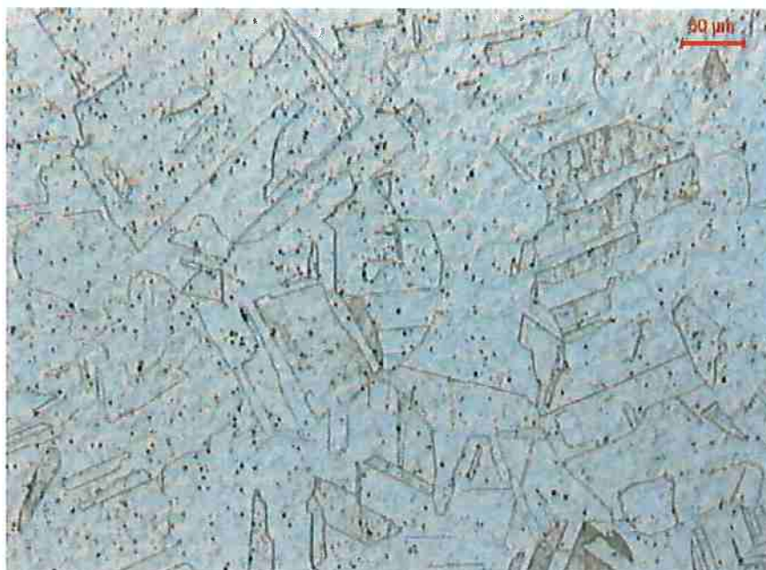
Figura 23 Microestrutura do Aço AISI 304 para o desgaste por cavitação (200X, Ácido Oxálico 10%).
