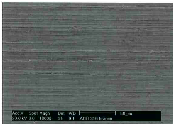
Figura 61 Superfície do aço AISI 316 com lixa 320.
