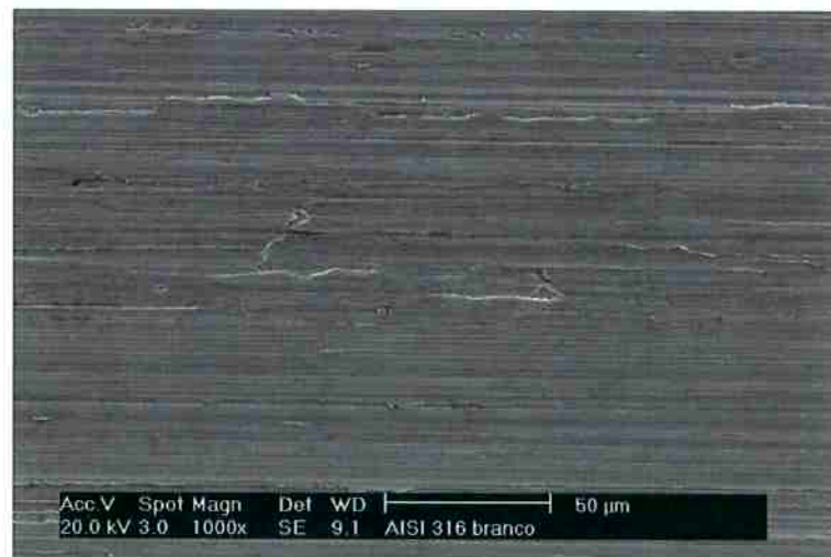
Figura 40 Superfície do aço AISI 316 polida com lixa 320.
