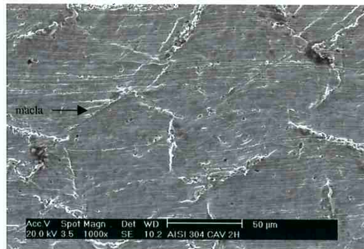
Figura 42 Superfície do aço AISI 304 com 120 minutos de cavitação em água destilada.
