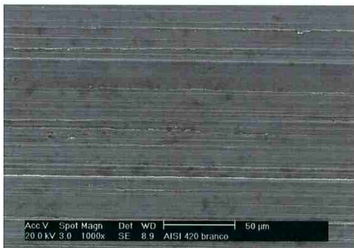
Figura 62 Superfície do aço AISI 420 com lixa 320.
