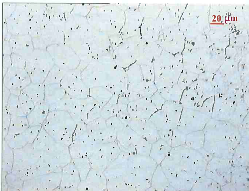
Figura 21 Microestrutura do Aço AISI 316 para o desgaste por deslizamento (100X, Ácido Oxálico 10%).
