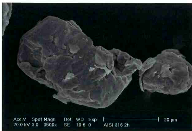
Figura 67 Imagem por MEV das partículas de desgaste após 3000 m do aço AISI 316 apresentando arredondamento nas bordas.
