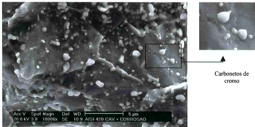
Figura 38 Superfície do aço AISI 420 com 120 minutos de desgaste em NaCl com presença de carbonetos de cromo.
