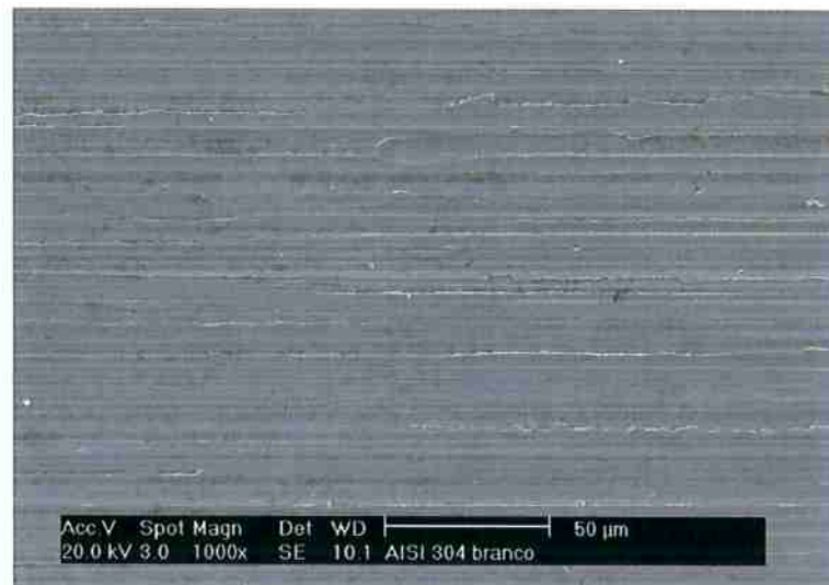
Figura 39 Superfície do aço AISI 304 polida com lixa 320.
