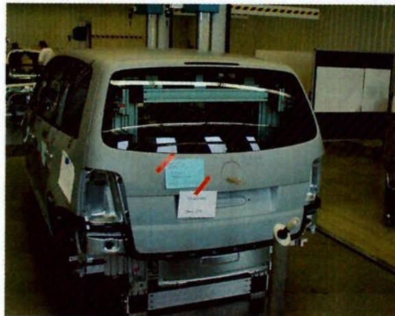
Fig. 12-2: Representação do Meisterbock Digital e o modelo e chapa construído para avaliação das peças estampadas que irão compor uma carroceria. No Meisterbock digital podemos já em avançado identificar futuros problemas de qualidade nas peças.
