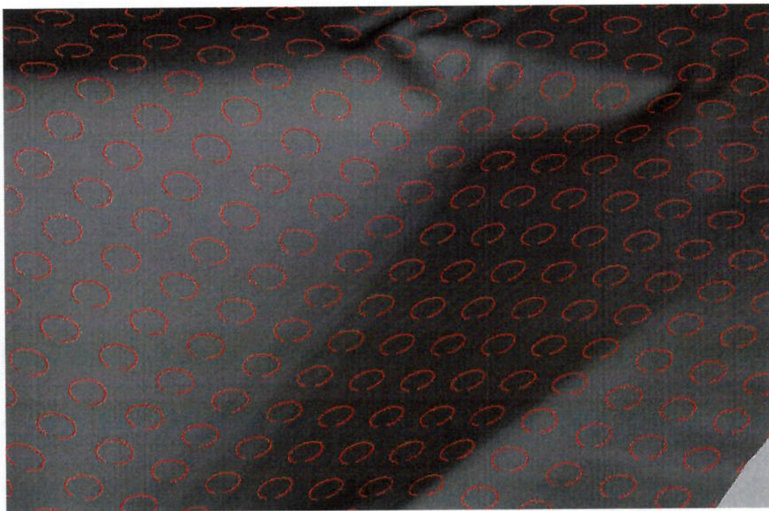
Fig. 10-15: Representação do grid de círculos sobre o blank no final da simulação 1, fase 1, iniciando-se a simulação para o estágio final (fase 2).
