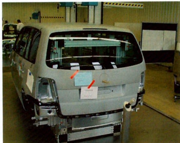
Fig. 12-2: Representação do Meisterbock Digital e o modelo e chapa construído para avaliação das peças estampadas que irão compor uma carroceria. No Meisterbock digital podemos já em avançado identificar futuros problemas de qualidade nas peças.
