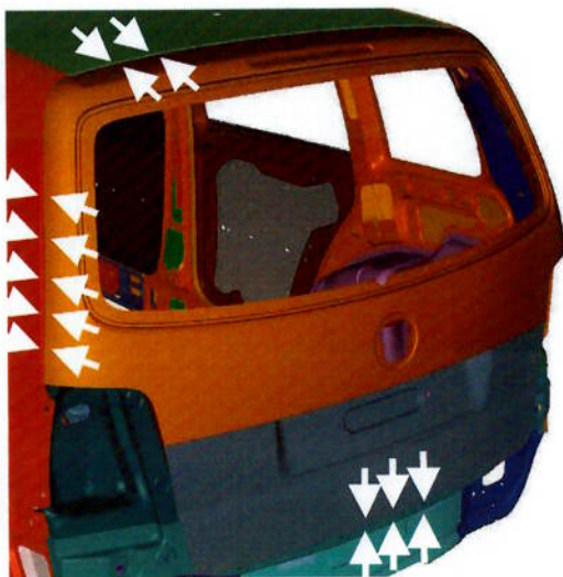
Fig. 12-2: Representação do Meisterbock Digital e o modelo e chapa construído para avaliação das peças estampadas que irão compor uma carroceria. No Meisterbock digital podemos já em avançado identificar futuros problemas de qualidade nas peças.
