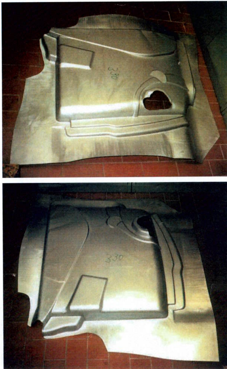
Fig. 10-11: Apresentação da peça estampada (protótipo) em ferramental de baixa produção com a simulação, resultados obtidos equivalente ao estágio 7 da simulação. Observa-se as semelhanças de comportamento com a região do alojamento da lanterna e com a região inferior da porta.
