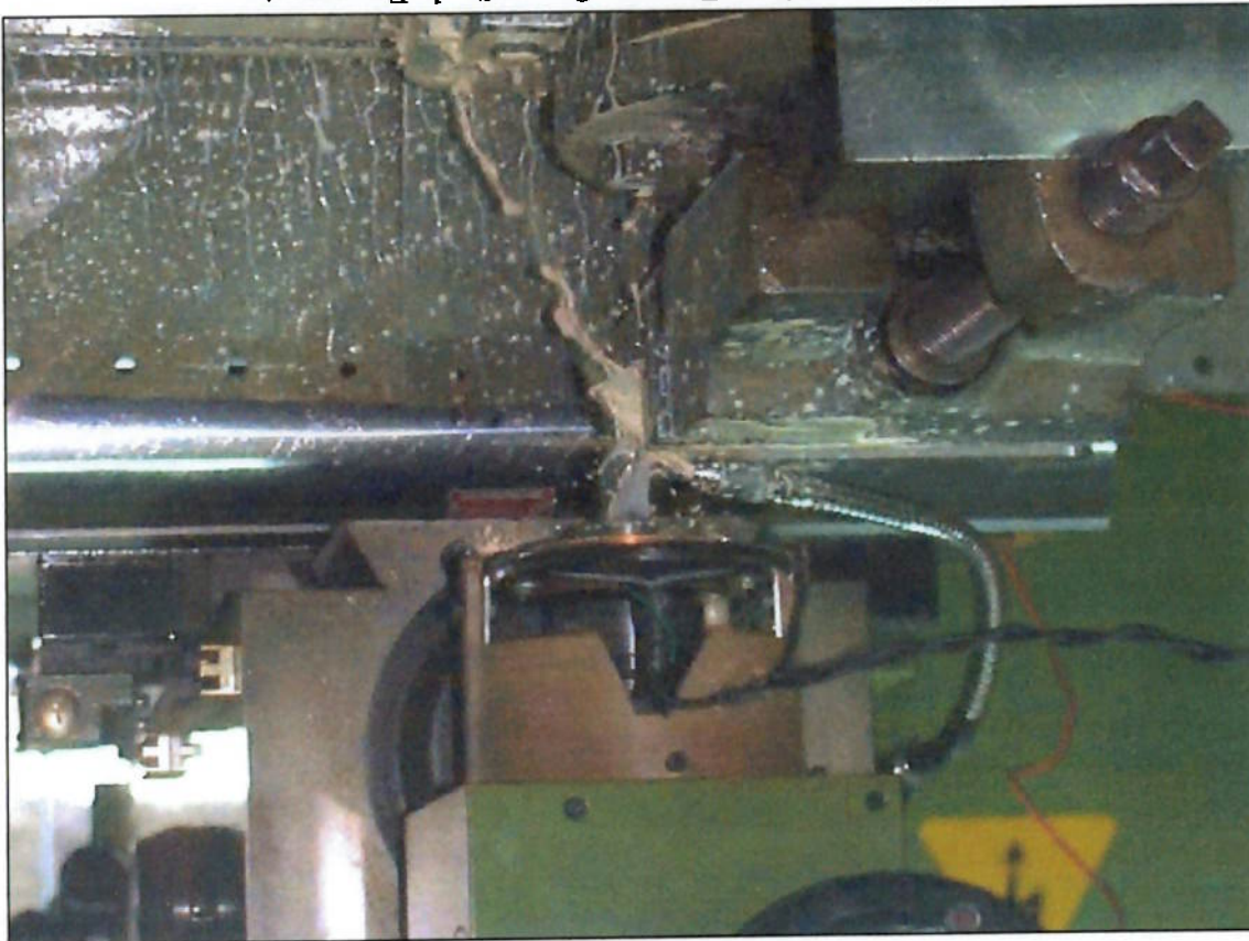
Foto 2.1: Transdutor Durante Operação de Fresamento.
