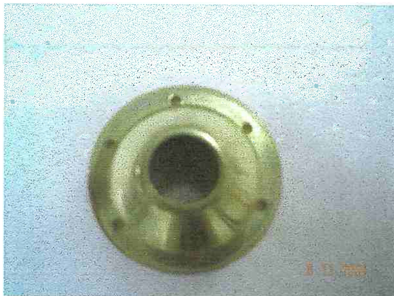
Fig. 4.9 – Orifícios de saída de ar por fora da cavidade
