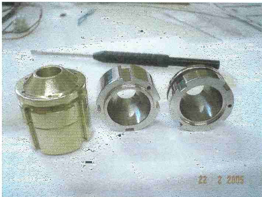
Fig. 4.15 – À esquerda, cavidade de ouro montada e à direita, cavidade de níquel sem montagem
