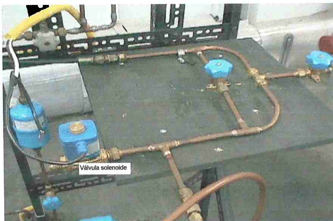
Figura 6.7 Dispositivo de controle de pressão do refrigerante.
