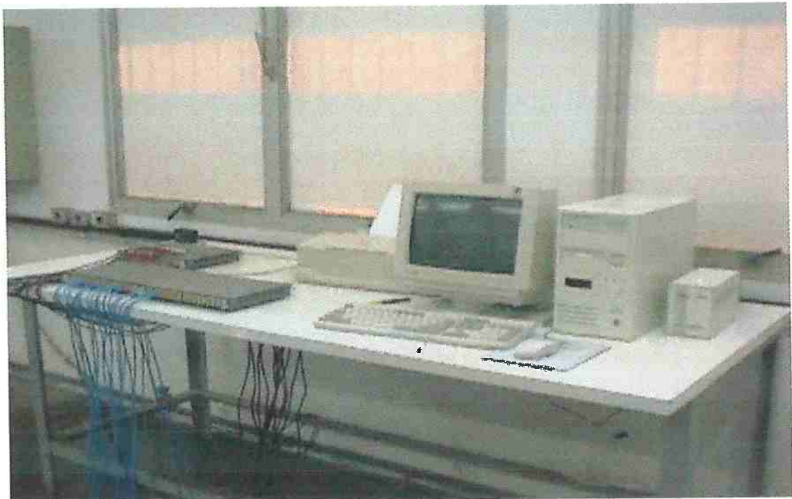
Figura 6.26 Vista geral do sistema de aquisição de dados junto com os conversores e as conexões dos termopares.
