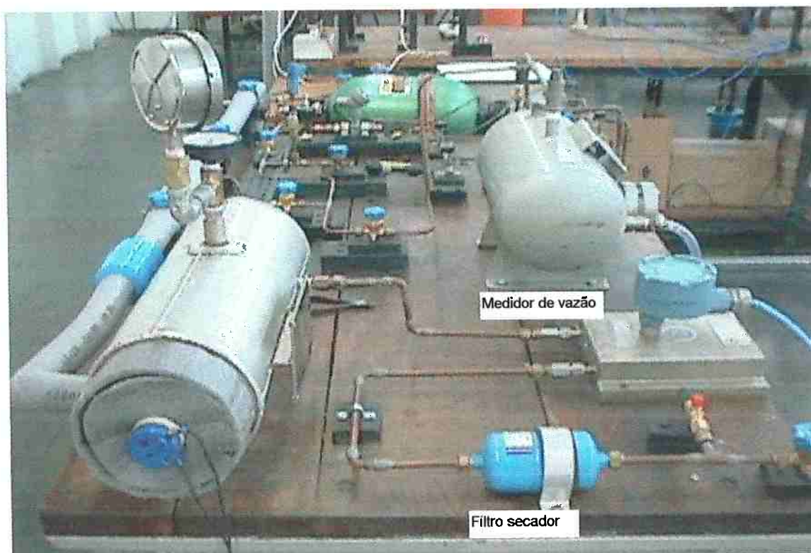
Figura 6.8 Medidor de vazão tipo Coriolís e filtros secadores instalados a montante da seção de testes.
