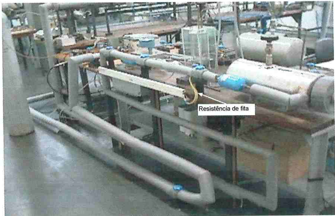
Figura 6.10 Vista do sistema de aquecimento do refrigerante para controle do subresfriamento utilizando resistência de fita
