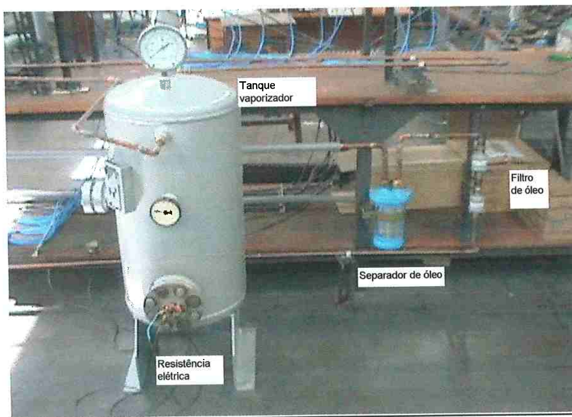
Figura 6.20 Sistema de separação do óleo lubrificante.
