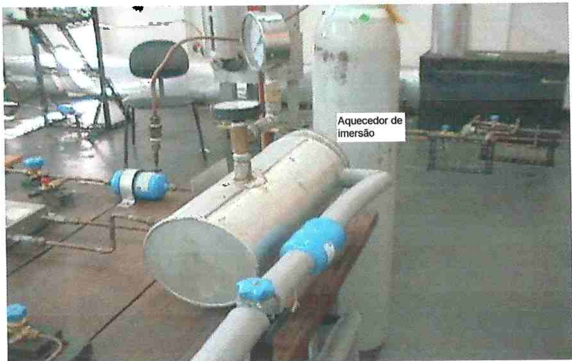
Figura 6.11 Sistema de controle de subresfriamento- aquecedor de imersão.
