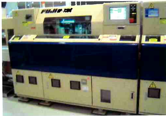
Figura 8.10 – Máquina Posicionadora Tipo “pick and place”, marca FUJI, modelo CP-7
