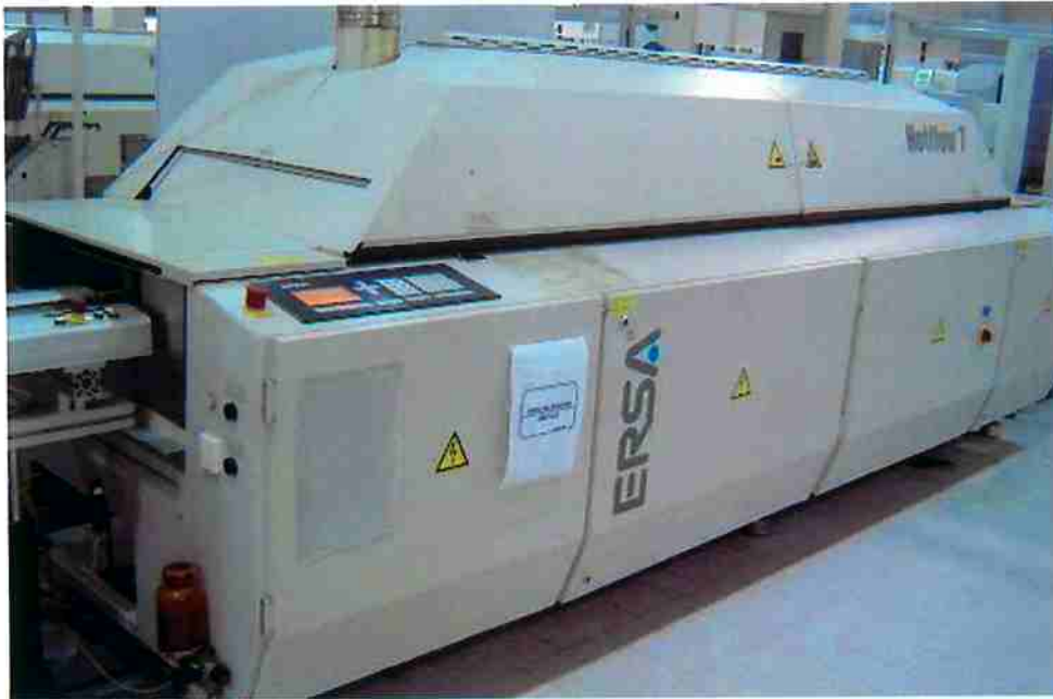
Figura 8.7 – Forno ERSA ® para Refusão da Pasta de Solda de Componentes Eletrônicos
