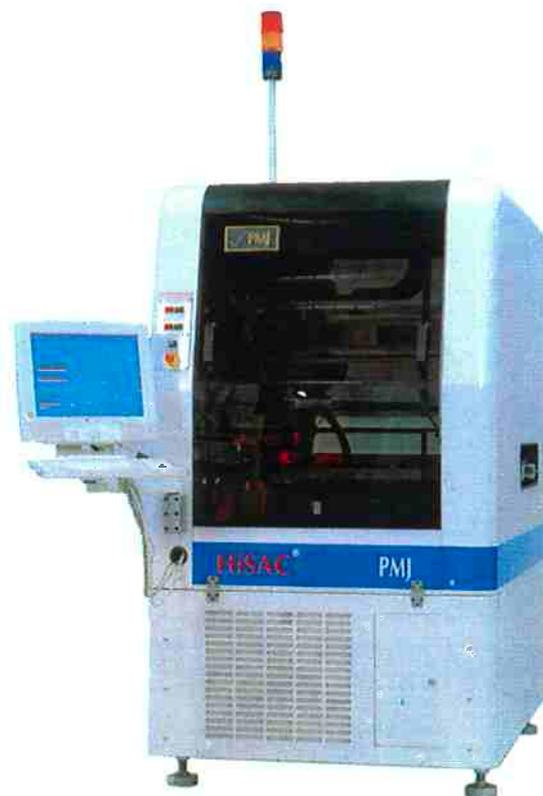
Figura 8.21 – Máquina *ROUTER* Analisada, do Fabricante PMJ, Modelo HiSAC 1000
