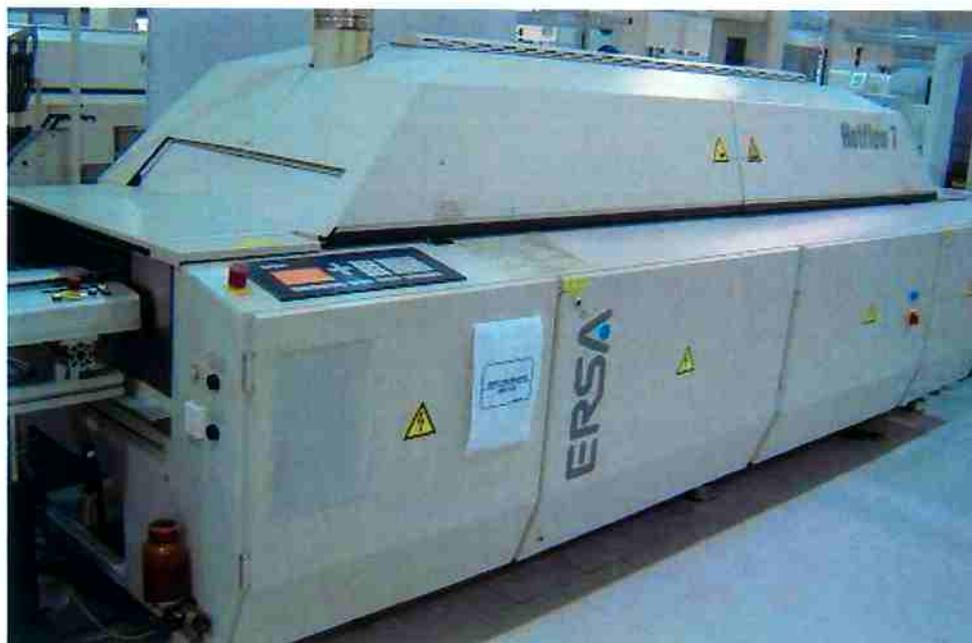
Figura 8.7 – Forno ERSA<sup>®</sup> para Refusão da Pasta de Solda de Componentes Eletrônicos
