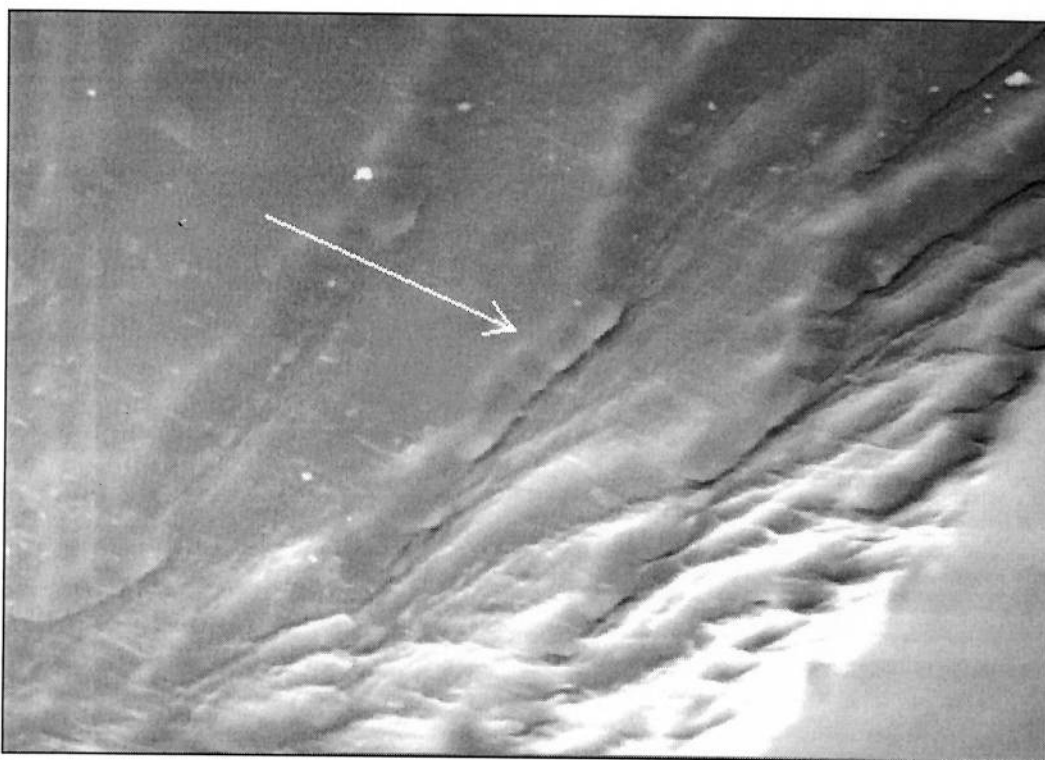
Figura 4. 4 - Detalhe da superfície de desgaste, mostrando ondulação provocada por deformação plástica (500 x). A seta indica o sentido de deslizamento.
