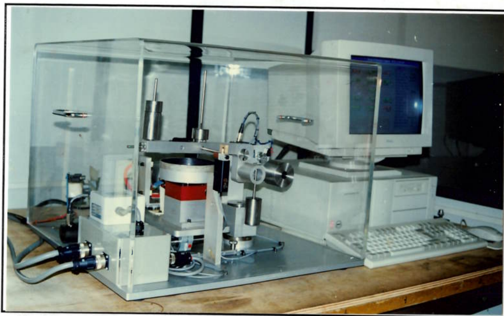
Figura 3. 5 - Equipamento pino-contra-disco com campânula de acrílico.
