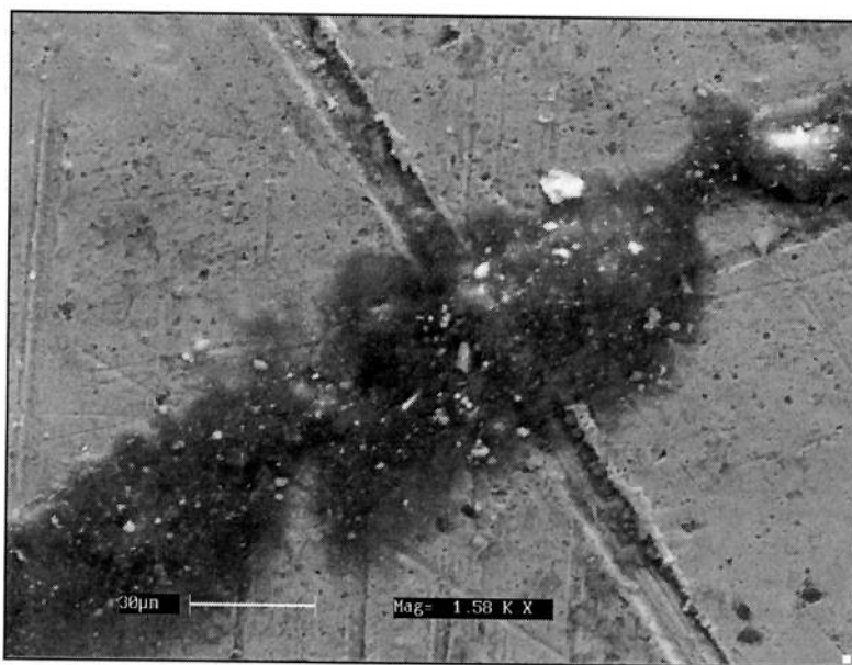
Figura 4. 5 - Micrografia da superfície do disco apresentando a presença de filme de transferência de PEAD (1580 x).
