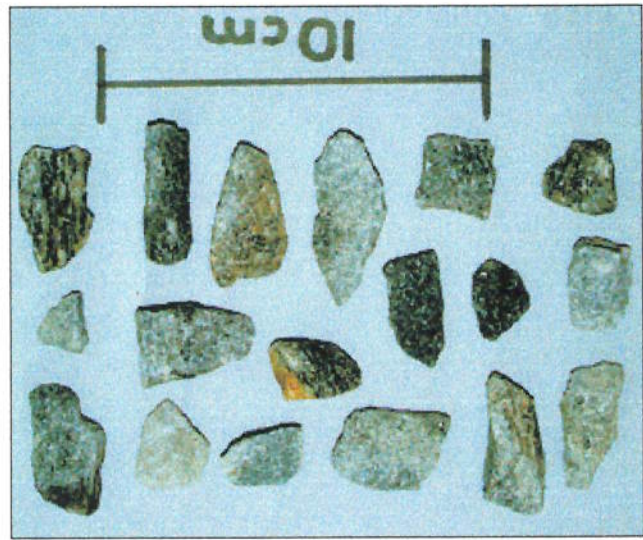
Figura 5.4 - Fotografia ilustrando granulometria de alimentação Brita
