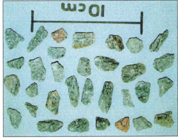
Figura 5.3 – Fotografia ilustrando granulometria de alimentação Brita Fina
