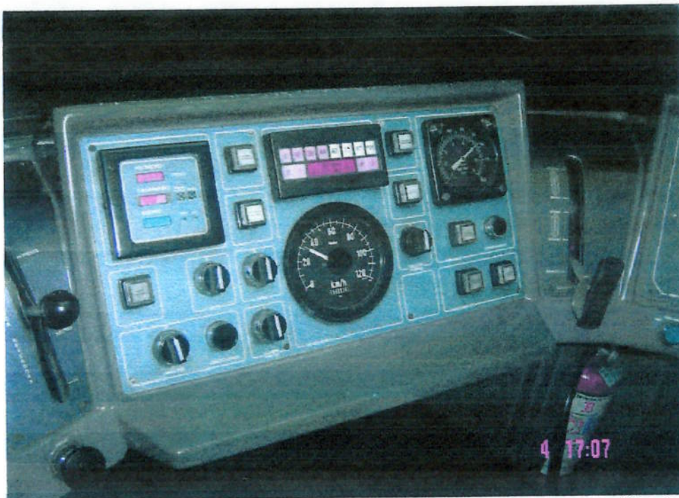
Figura 4.38 – Painel do Metrô. No centro dele está o velocímetro utilizado para coletar as medidas de referência (velocidades instantâneas, de 10 em 10 segundos, da composição).
