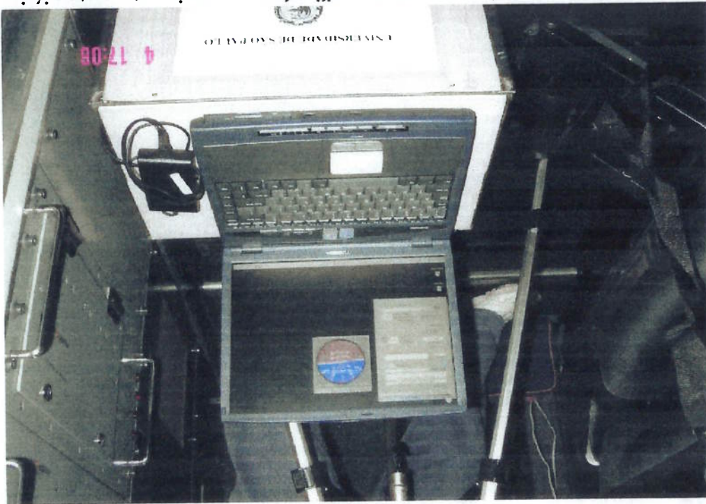
Figura 4.36 – Aspecto da instrumentação utilizada no experimento metroviário. No notebook está instalado o software Gyroview, como se pode observar na tela, e na caixa montada abaixo do notebook estão as baterias utilizadas para alimentação do sistema e a Central Inercial strapdown.
