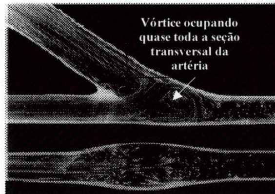
Figura 127. Escoamento fotografado numa fistula arteriovenosa com ângulo de anastomose de 30° (Sivanesan et al. , 1999b).
