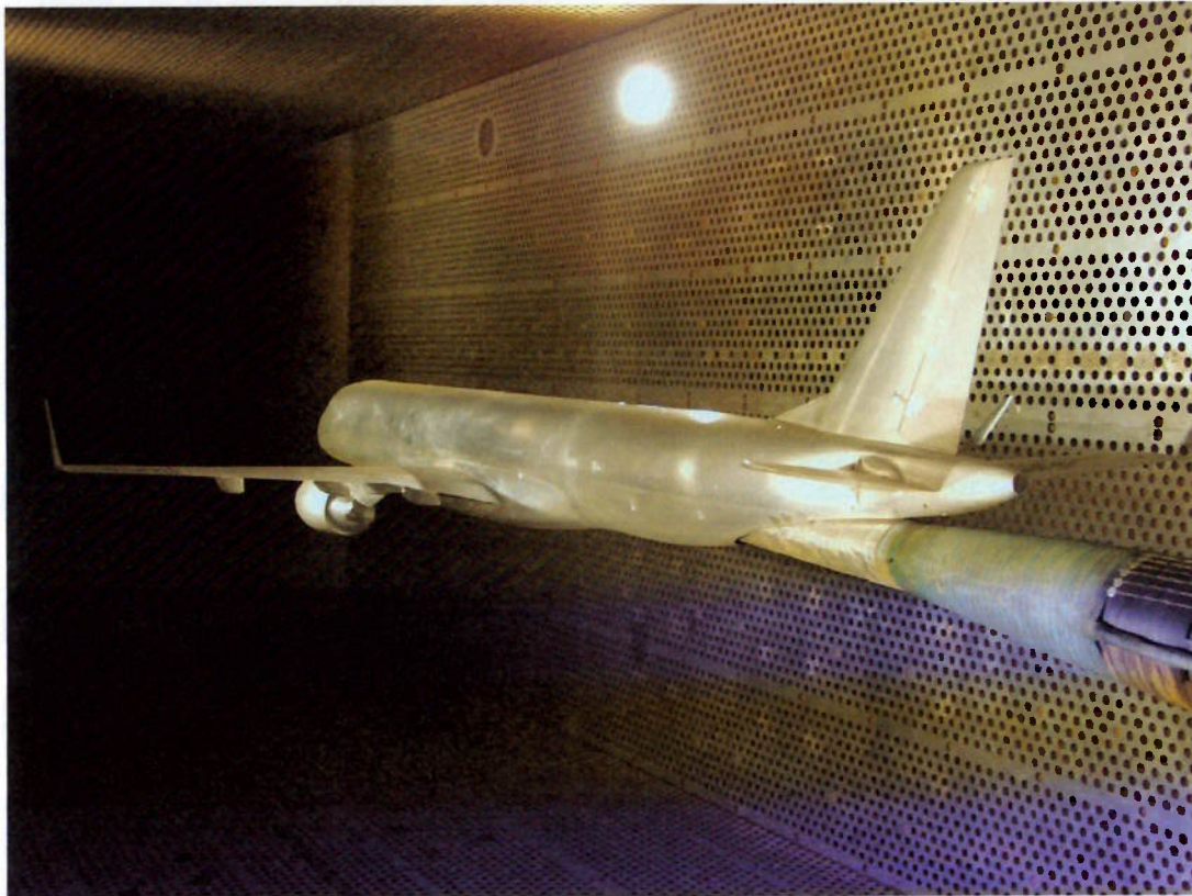
Figura 1.1. Modelo (X-RJ) com empenagem baixa e suporte tipo sting traseiro em ensaio de túnel de vento na Rússia (TsAGI).
