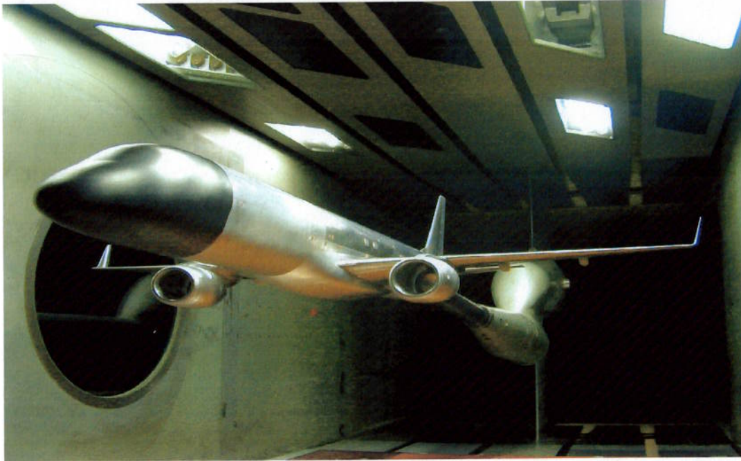
Figura 4.1. Modelo do X-RJ no túnel de vento (DNW-HST)
