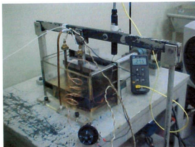
Figura 6-12 Aquecimento do banho de óleo por termostato
