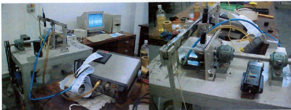
Figura 6-13: Registro de contaminação com contador de partículas
