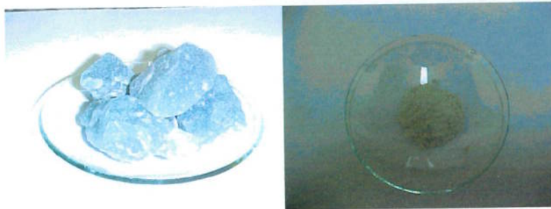
Figura 6-7. Quartzo em lascas e após moagem
