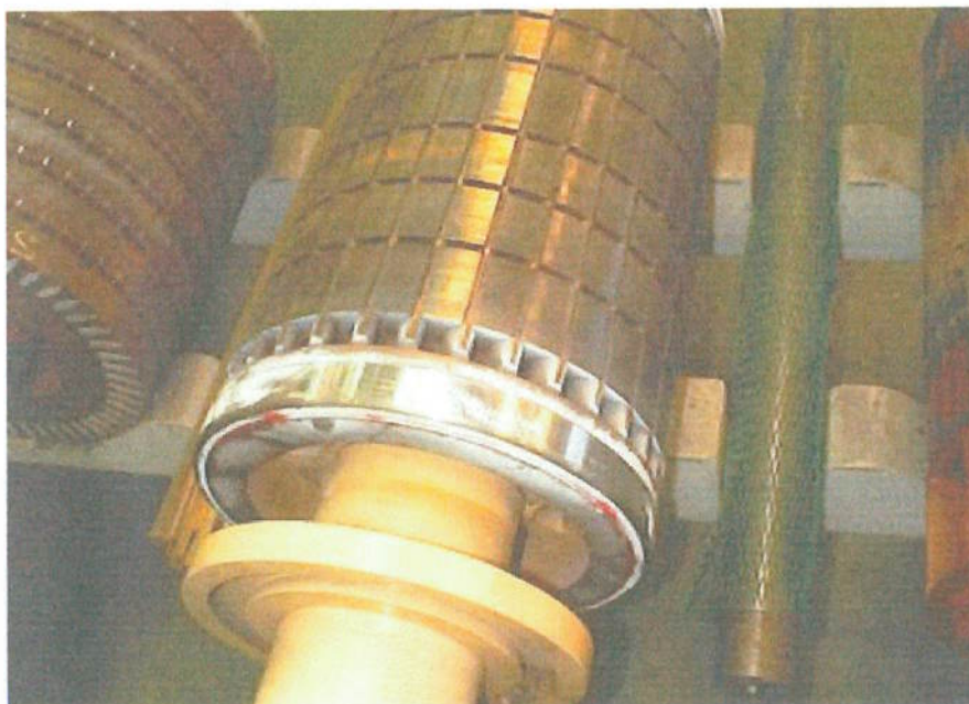
Figura 12 – Um rotor gaiola de esquilo, similar ao rotor utilizado nos estudos de caso.
