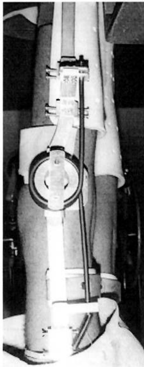
Figura 9 - Foto do dispositivo desenvolvido acoplado à órtese do paciente com o qual se realizaram os testes. Nesse estado, a mola está acoplada, exercendo torque na articulação do joelho e armazenando energia potencial. A articulação do joelho está travada.
