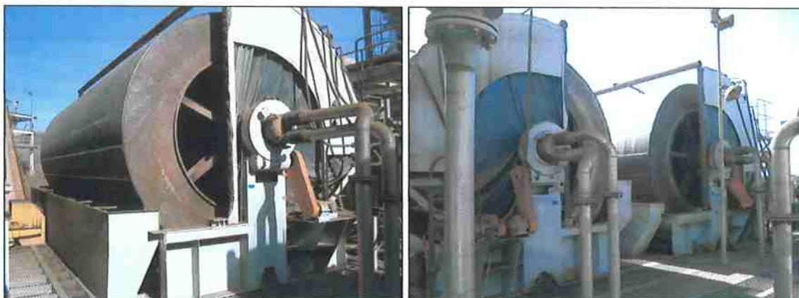
**Figura B.9 – Vista dos filtros rotativos à vácuo**
