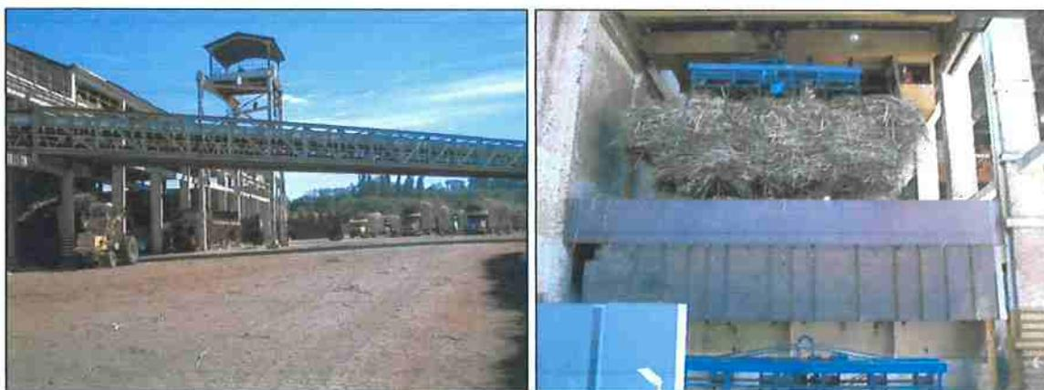
**Figura B.3 – Vista dos treminhões abastecendo a usina e da ponte rolante para descarrega**
