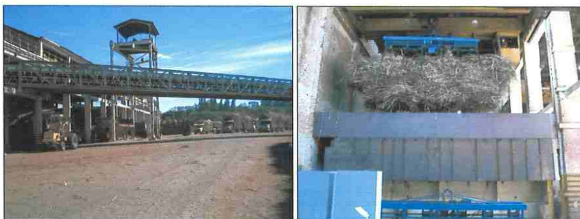
Figura B.3 – Vista dos treminhões abastecendo a usina e da ponte rolante para descarrega
