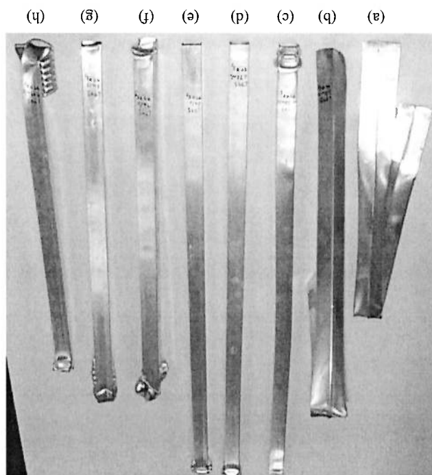
Figura 5.5: Tubos de L = 745\text{mm} ensaiados com G = 97.9\text{kg} e V_0 de (a) 1.41\text{m/s} , (b) 1.5\text{m/s} , (c) 1.53\text{m/s} , (d) 1.71\text{m/s} , (e) 2\text{m/s} , (f) 4\text{m/s} , (g) 6\text{m/s} e (h) 9.94\text{m/s} .
