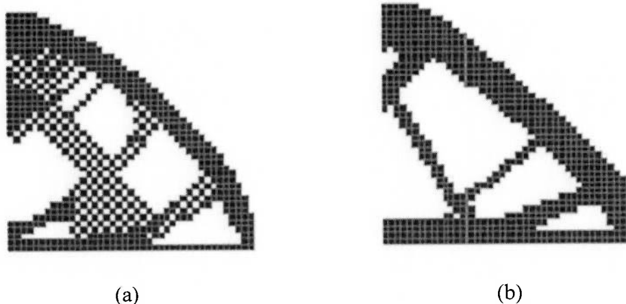
Figura 4.3: (a) Solução com o erro numérico de “instabilidade xadrez” (b) Solução sem o erro numérico de “instabilidade xadrez”
