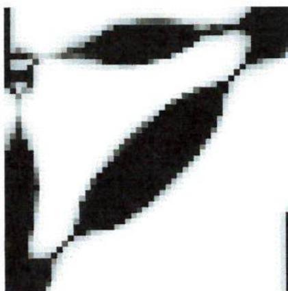
Figura 4 – Mecanismo flexível com compensação dos efeitos térmicos.
